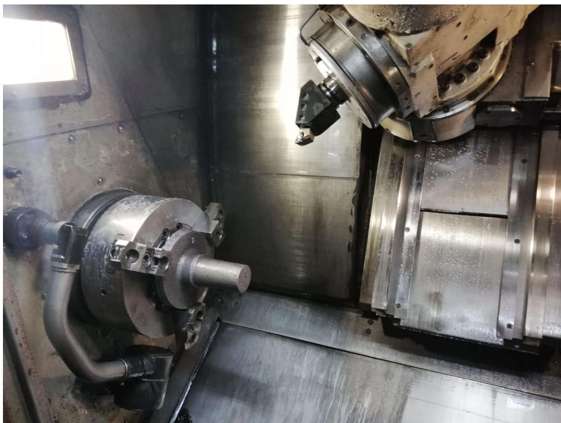
Slika 42. prikaz stezanja obratka u steznu glavu
