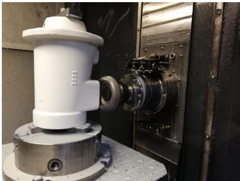
Slika 27. Prikaz čeonog glodanja
