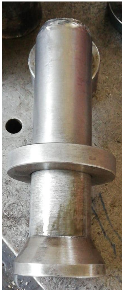
Slika 56. Naprava za uprešavanje zupčanika redukcije sa ležajem u reduktor
