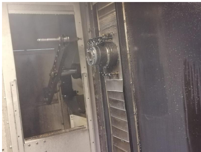
Slika 28. Automatska izmjena alata
