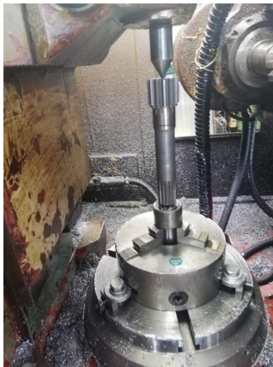
Slika 39. Prikaz zupčanika na striju
