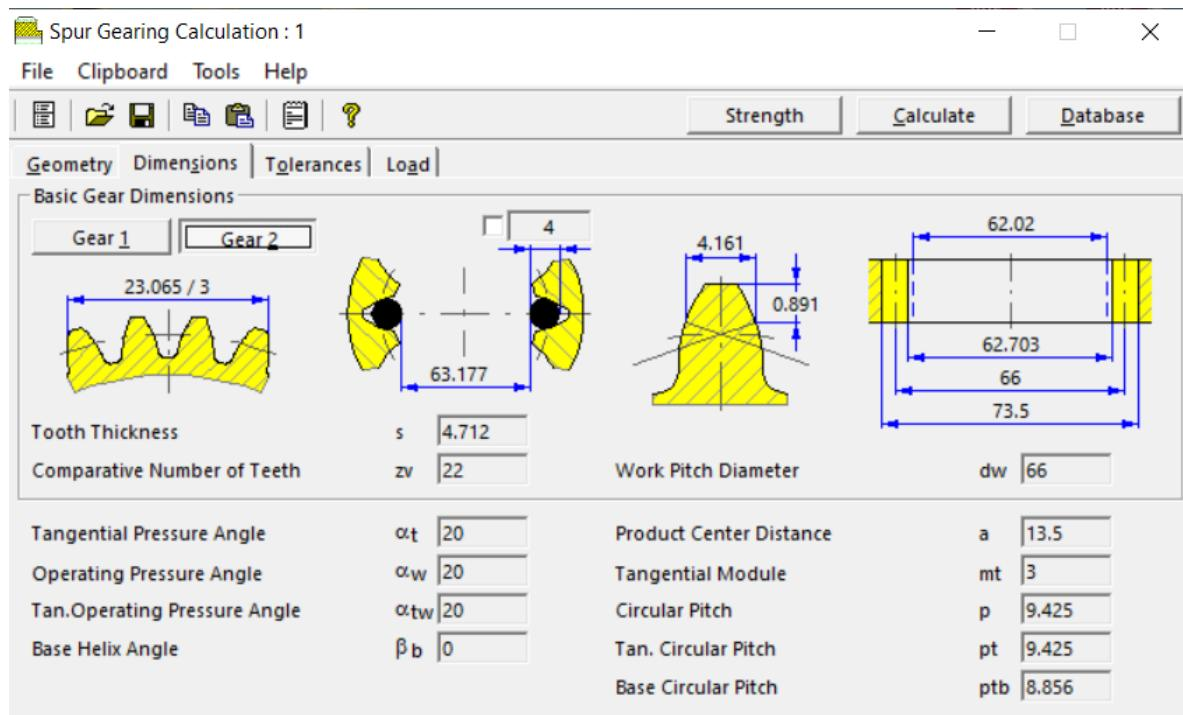
Slika 10. parametri za zupčanik sa unutašnjim ozubljenjem
