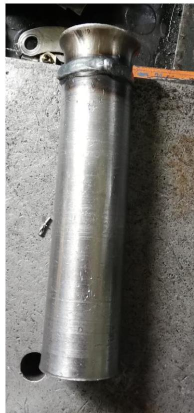
**Slika 55. Naprava za uprešavanje ležaja na zupčanik redukcije**
