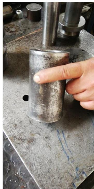
Slika 53. Naprava za uprešavanje ležaja na izlazno vratilo
