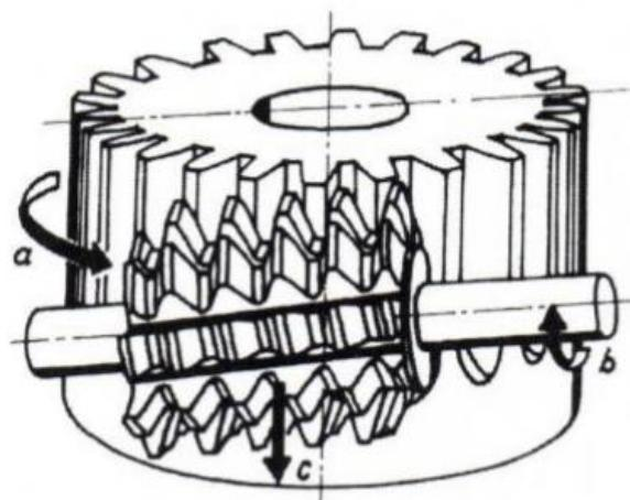
**Slika 38. Prikaz izrade zupčanika odvalnim glodanjem [10]**
