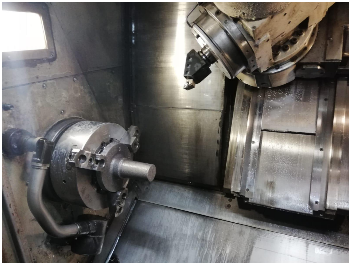
Slika 42. prikaz stezanja obratka u steznu glavu
