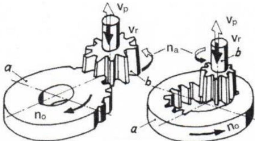
**Slika 34. Prikaz izrade zupčanika fellows postupkom [9]**
