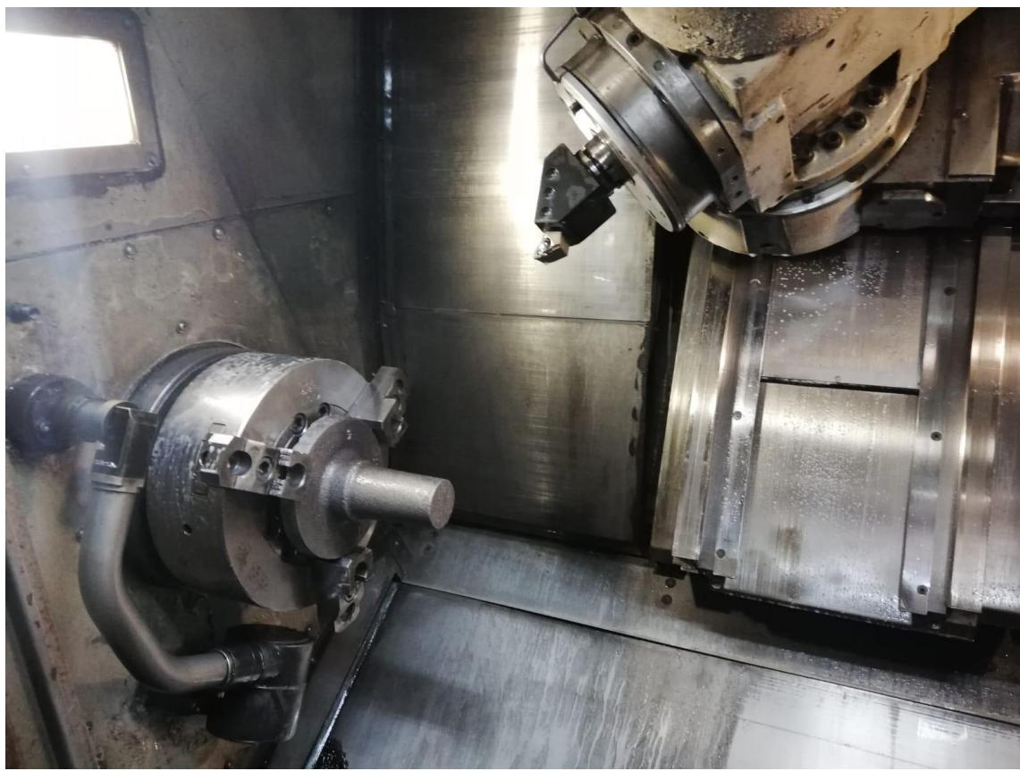
Slika 42. prikaz stezanja obratka u steznu glavu
