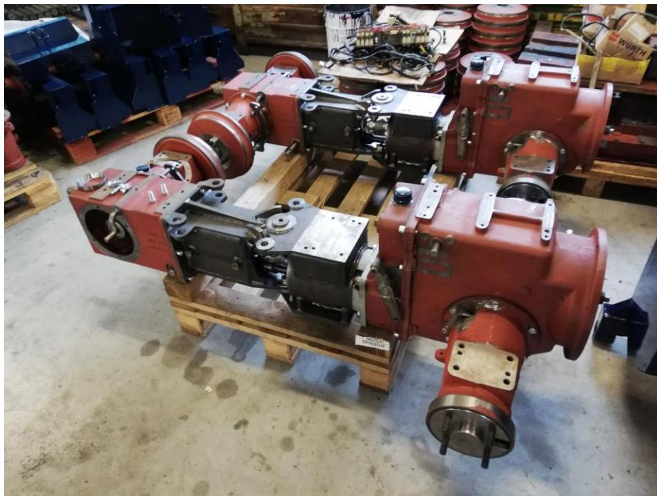
**Slika 58. Kućišta traktora**
