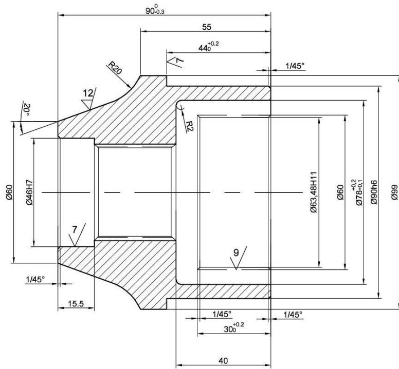
Slika 36. Crtež zupčanika sa unutarnjim ozubljenjem u presjeku
