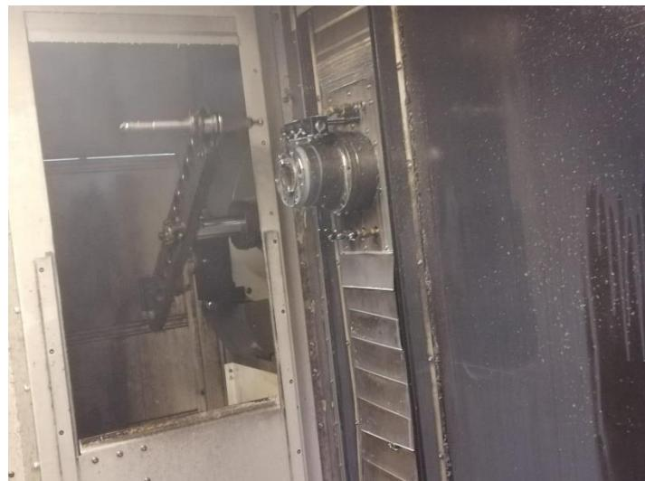
**Slika 28. Automatska izmjena alata**
