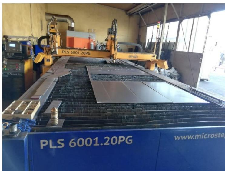
Slika 45. Stroj za plazma rezanje
