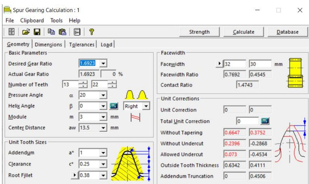
**Slika 8. Unošenje parametara**
