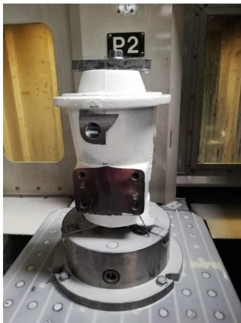
**Slika 25. Prikaz prvog stezanja kućišta**
