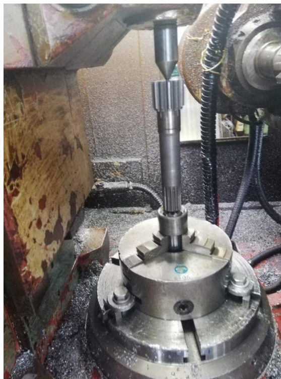
Slika 39. Prikaz zupčanika na striju
