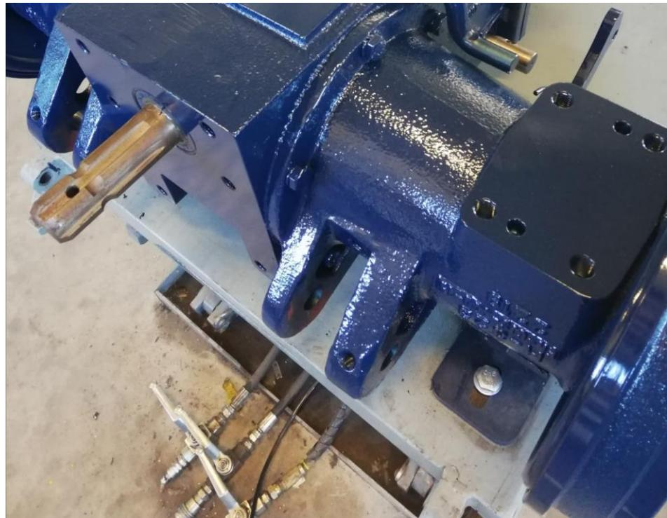
**Slika 57. Prikaz bočnog reduktora na zadnjem kućištu**
