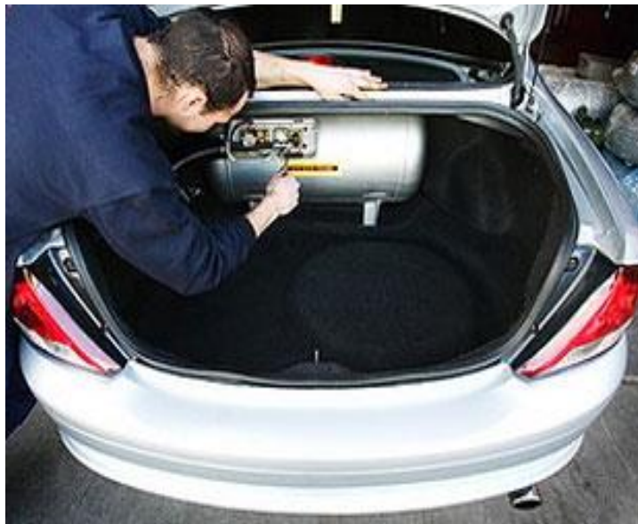
Slika 14. Ugradnja plinskog sustavu a automobil
