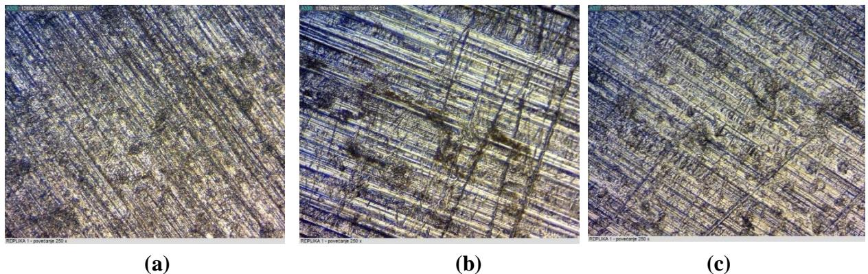
**Slika 12.** Površine aluminija snimljene optičkim metalografskim mikroskopom (250X) nakon 30 dana izlaganja u čistoj 3% otopini octene kiseline pri 4°C (a), pri 25°C (b) i s dodatkom 15 g/L rogača (c).
