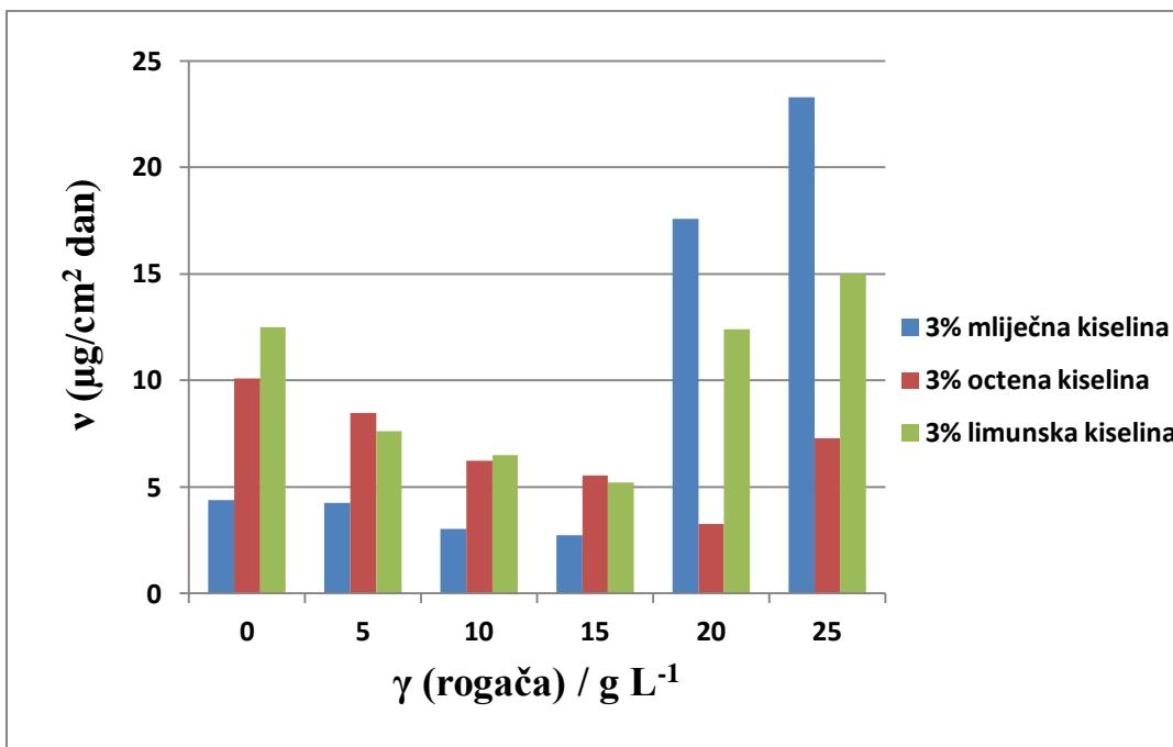
**Slika 9.** Brzine korozije aluminija ( $\mu\text{g}/\text{cm}^2$  dan) u otopinama organskih kiselina bez i sa dodatkom različitih koncentracija praha rogača određene gravimetrijskom metodom na  $25^\circ\text{C}$ .
