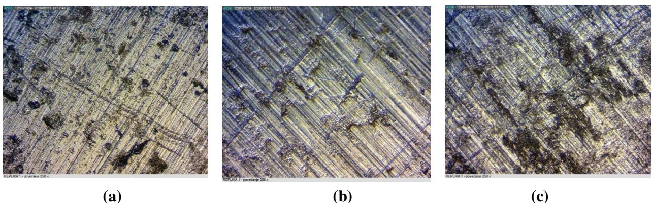
**Slika 13.** Površine aluminija snimljene optičkim metalografskim mikroskopom (250X) nakon 30 dana izlaganja u čistoj 3% otopini limunske kiseline (a), s dodatkom 15 g/L rogača (b) i 25 g/L rogača na 4°C.
