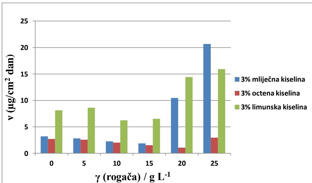
**Slika 8.** Brzine korozije aluminija ( $\mu\text{g}/\text{cm}^2 \text{ dan}$ ) u otopinama organskih kiselina bez i sa dodatkom različitih koncentracija praha rogača određene gravimetrijskom metodom na +4°C.
