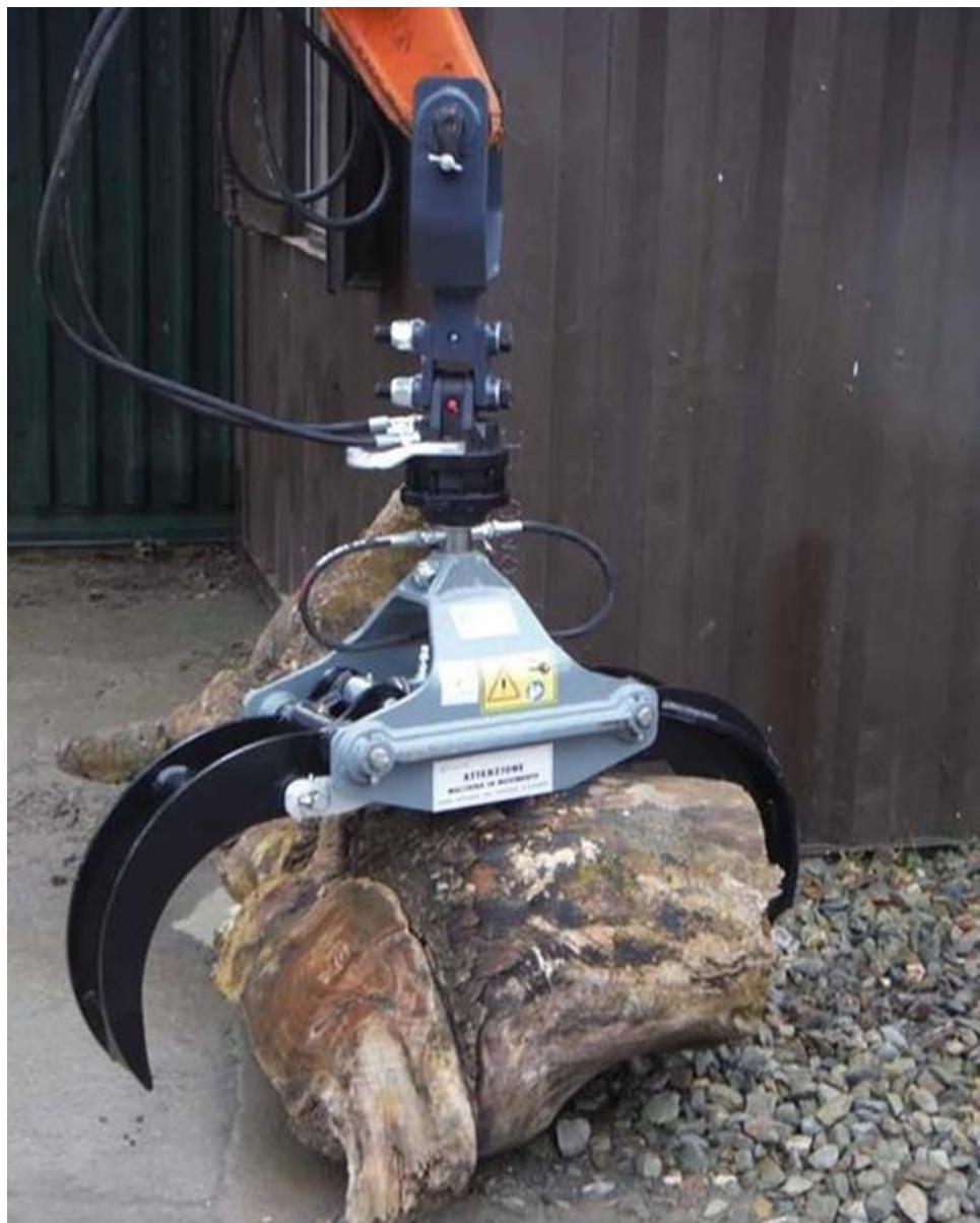
Slika 2. 1. Hidrauličke škare za trupce s rotatorom. [6]
