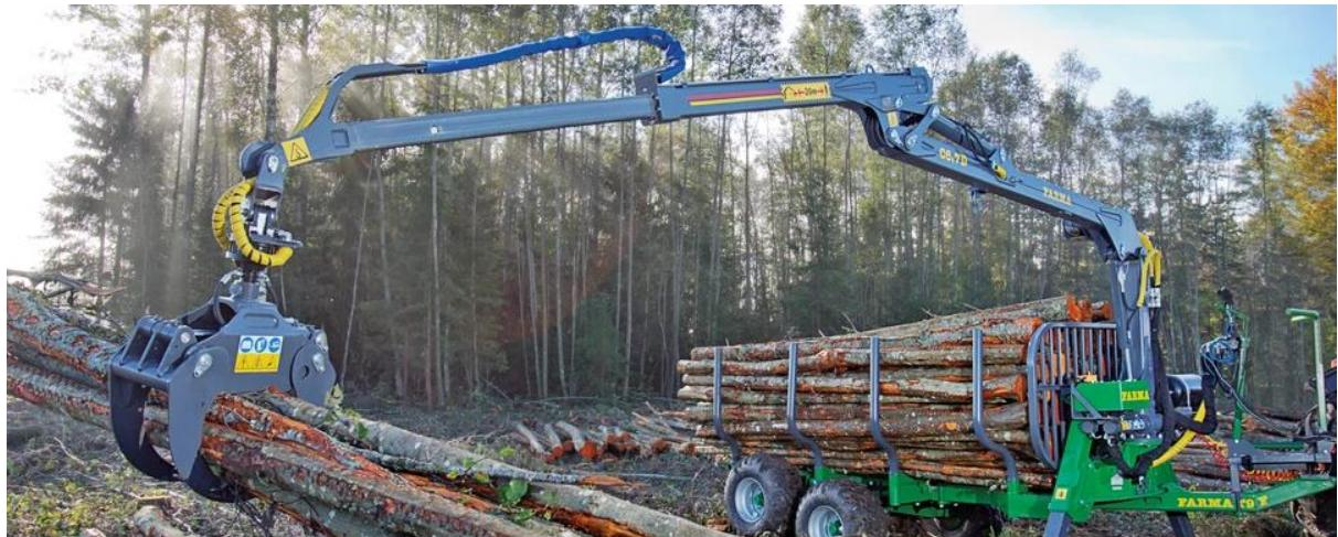
Slika 2. 2. Hidrauličke škare priključene na dizalicu. [8]
