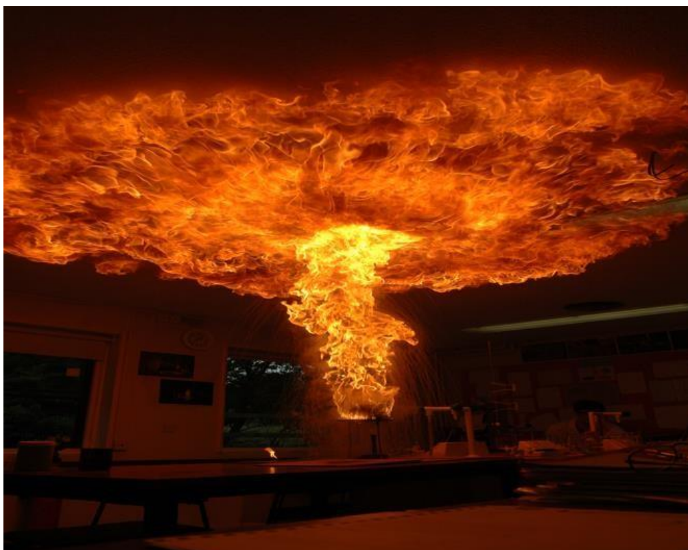
Sl. 8. Karakterističan način širenja požara ulja i masti [9]
