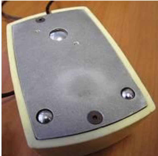
Slika 8: Donja strana Xerox Alto računalnog miša [6]
