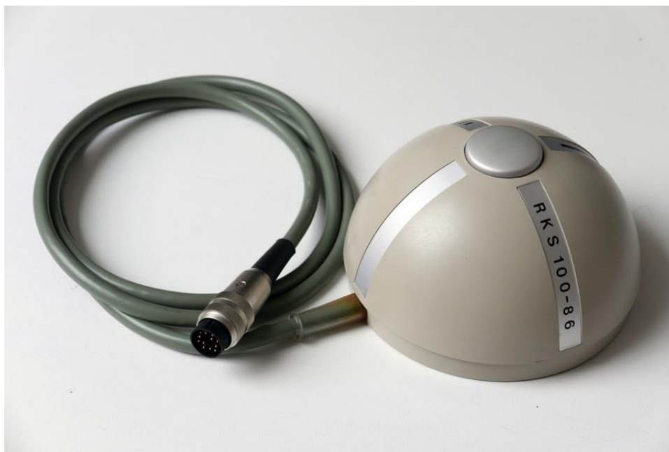
Slika 5: Rollkugel (od njem. kotrljajuća lopta) [4]
