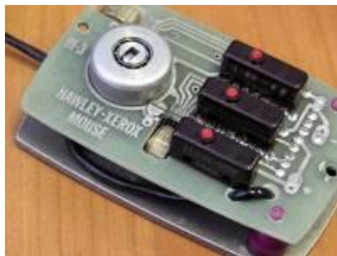
Slika 9: Prikaz unutarnjeg djela Xerox Alto računalnog miša [6]
