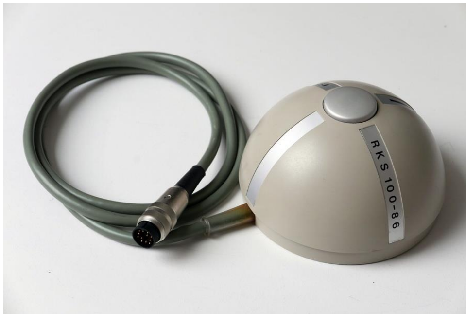
Slika 5: Rollkugel (od njem. kotrljajuća lopta) [4]
