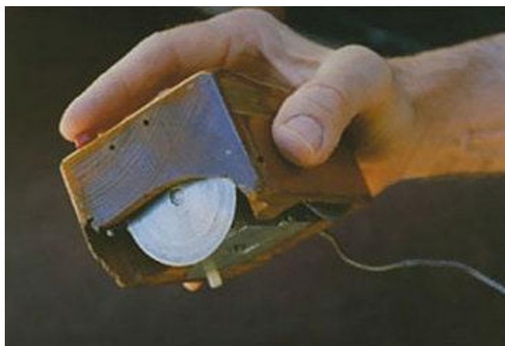
Slika 2: Prototip prvog računalnog miša [2]
