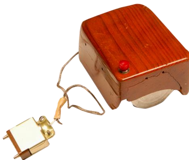
Slika 3: Prototip prvog računalnog miša [3]
