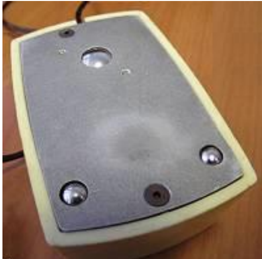
Slika 8: Donja strana Xerox Alto računalnog miša [6]
