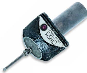
Slika 8. Prva mjerna glava s kontaktnim ticalom [16]
