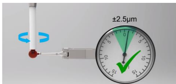
Slika 35. Preporučeno dozvoljeno odstupanje od \pm 2,5 \mu\text{m} centra osi rotacije kontaktnog ticala 3D mjerne glave od centra osi vretena obradnog centra [26]
