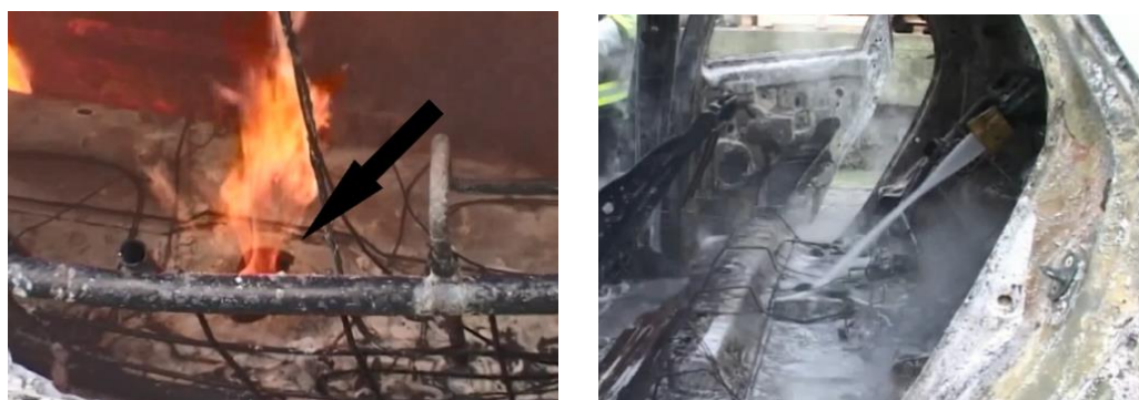
Slika 15. Otvor na kućištu električne baterije [Izvor: Vlastita arhiva]
