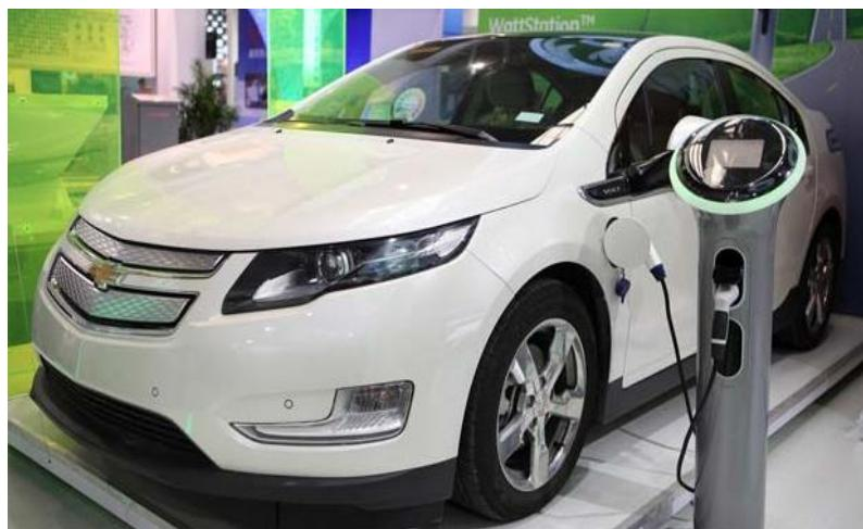
Slika 5. Chevrolet Volt, električno vozilo s produljenim dometom
