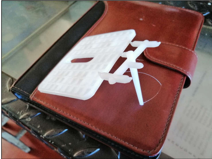
Slika 37. Gotov proizvod sa viškom materijala
