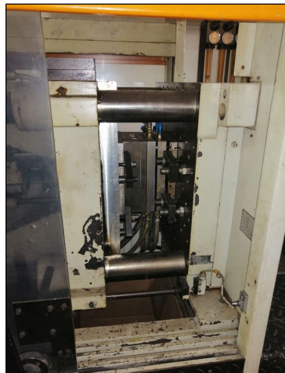
Slika 36. Prikaz zatvorenog alata
