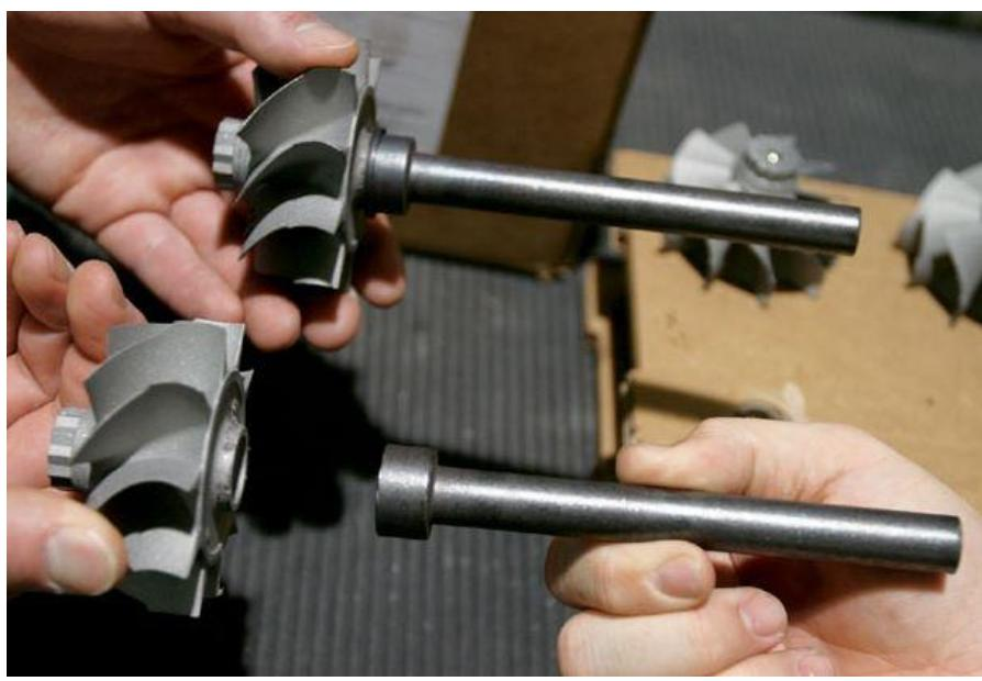
**Slika 17 Turbinsko vratilo – spajanje [12]**
