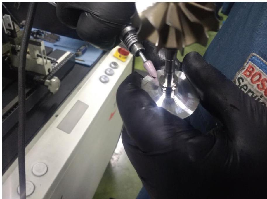
Slika 51 Uklanjanje mase - kompresijski rotor [17]
