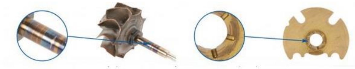
Pregrijavanje/zaribavanje uslijed manjka tlaka ulja
