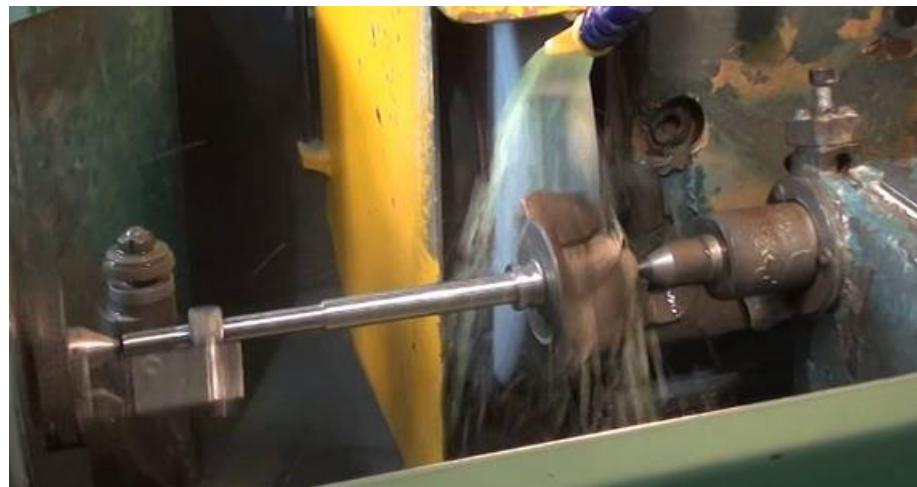
**Slika 18 Brušenje turbinskog rotora [12]**
