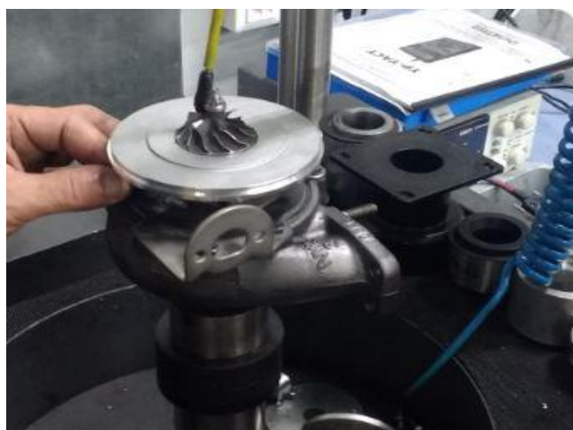
Slika 62 Podešenje protoka varijabilne geometrije [17]
