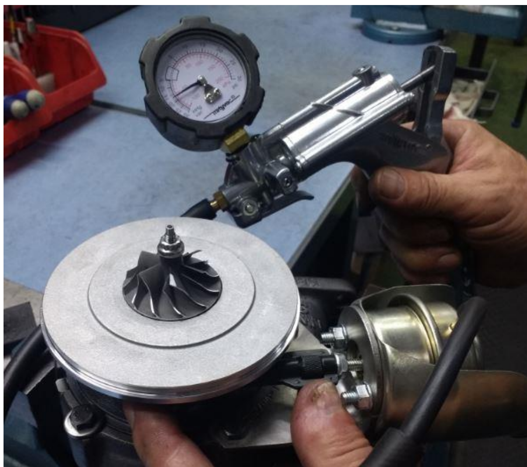
Slika 64 Podešavanje vakuumskog akuatora [17]
