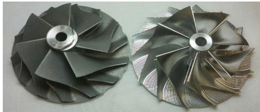
**Slika 20 Lijevani te kovano/glodani kompresijski rotor [14]**
