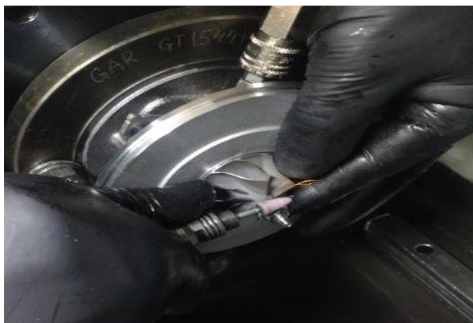
Slika 59 Uklanjanje viška mase na matici kompresijskog rotora [17]
