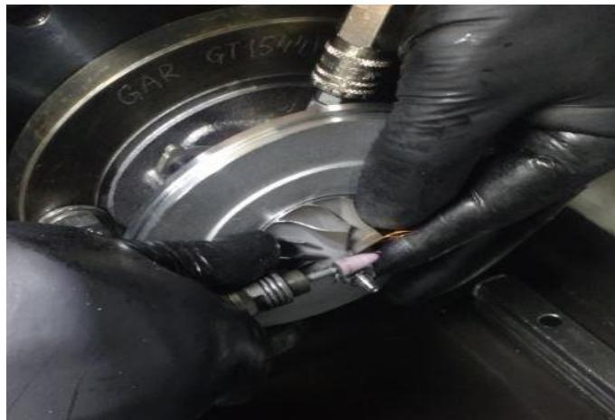
**Slika 59 Uklanjanje viška mase na matici kompresijskog rotora [17]**
