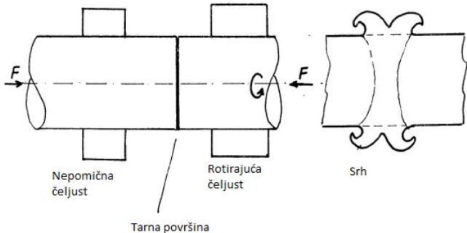
**Slika 16 Zavarivanje trenjem [11]**
