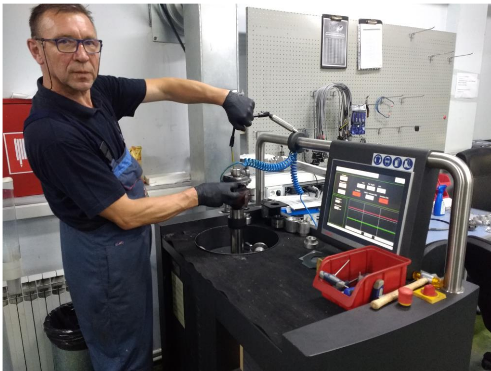
Slika 38 Mjerenje protoka varijabilne geometrije [17]
