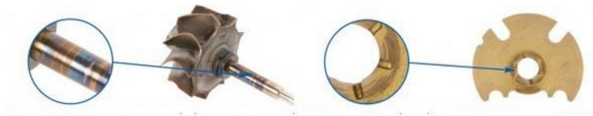
Pregrijavanje/zaribavanje uslijed manjka tlaka ulja
