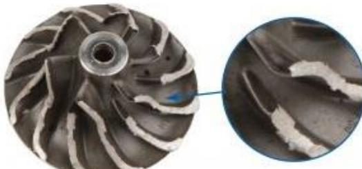
Oštećena ležajna mjesta/manjak podmazivanja/prevelika brzina vrtnje
