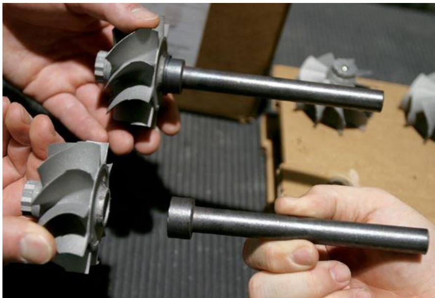
Slika 17 Turbinsko vratilo – spajanje [12]
