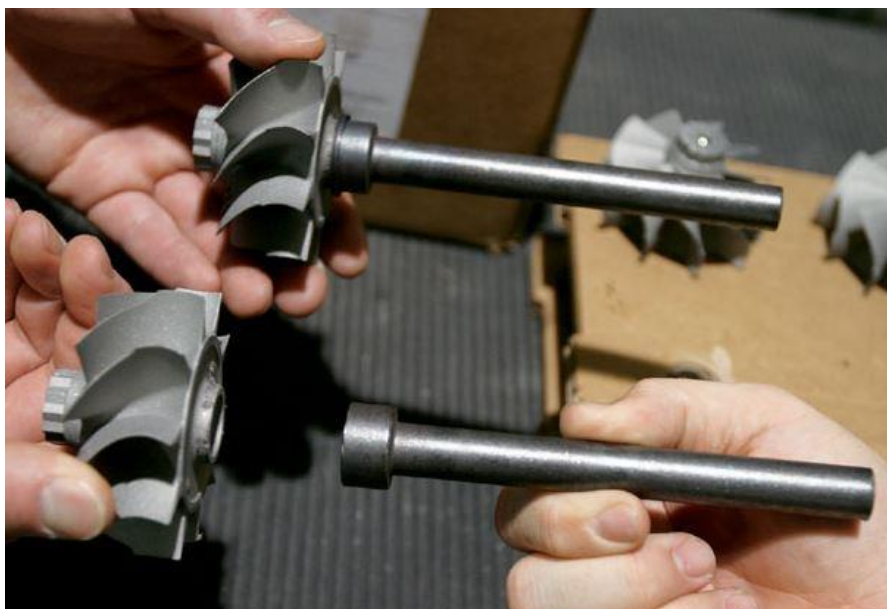
Slika 17 Turbinsko vratilo – spajanje [12]
