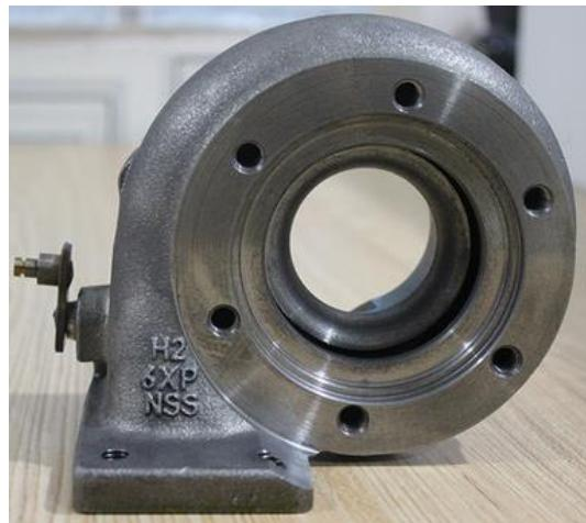
Slika 14 Duktilan SiMo lijev [9]
