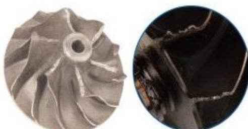
Oštećenja uslijed prolaza stranog tijela preko rotora
