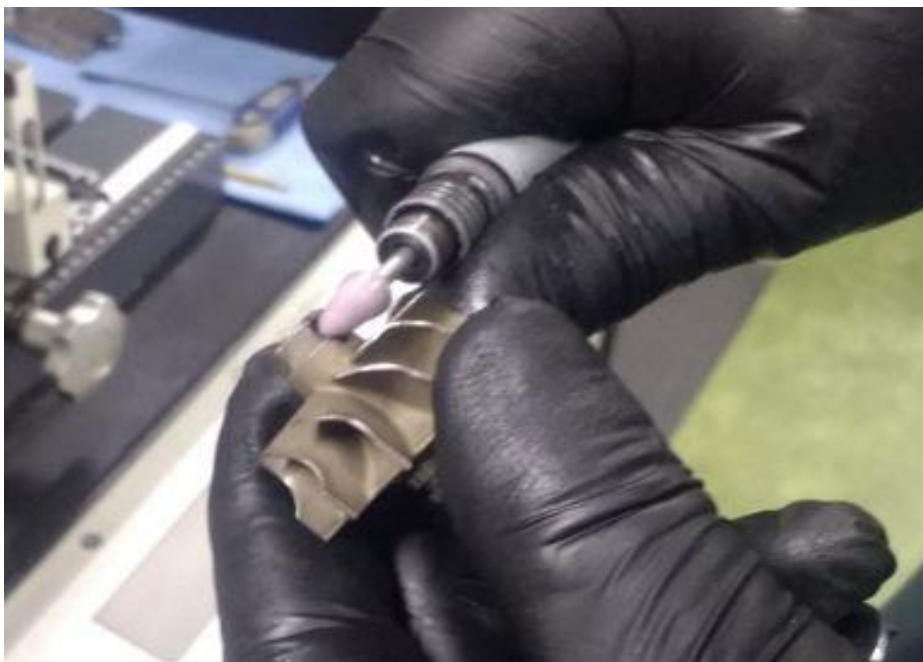
Slika 52 Uklanjanje mase - turbinski rotor [17]
