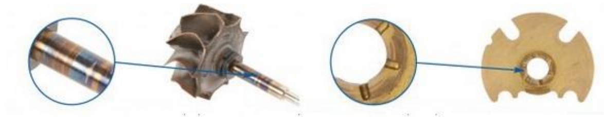
Pregrijavanje/zaribavanje uslijed manjka tlaka ulja
