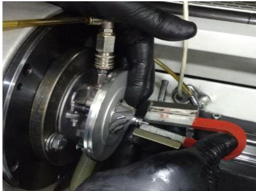
**Slika 57 Magnetizacija matice kompresijskog rotora [17]**
