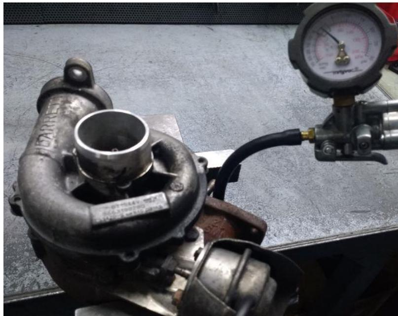
Slika 37 Vakuumska provjera podešenja aktuatora [17]
