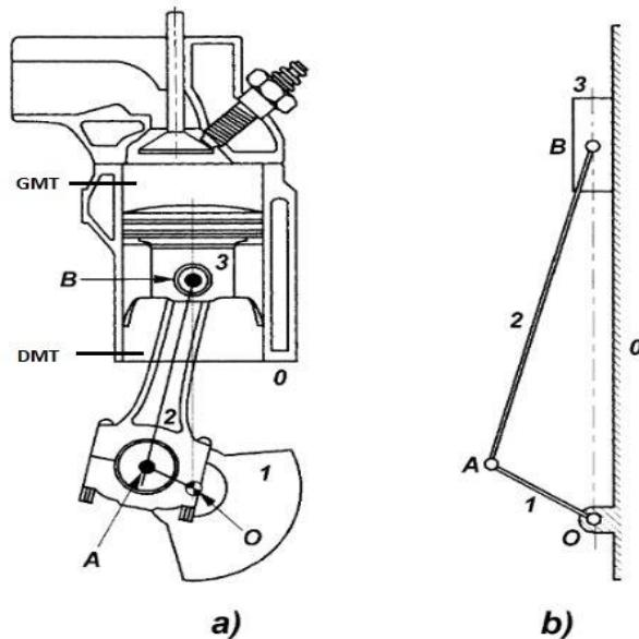
Slika 3 Klipni mehanizam [2]
