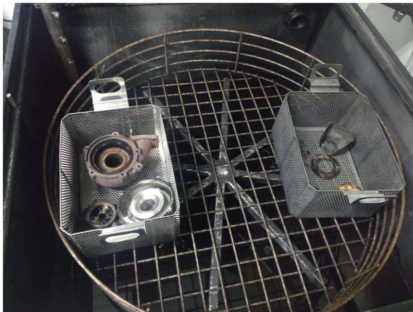
Slika 45 Pranje u industrijskoj perilici [17]
