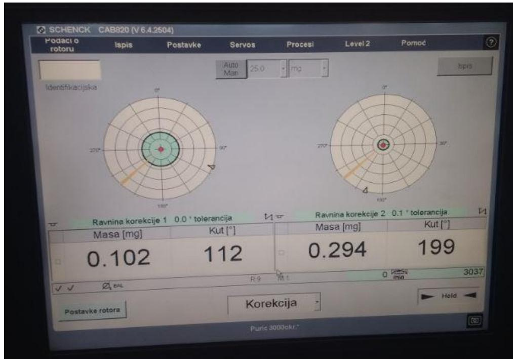
Slika 53 Finalni rezultat 1. balansiranja [17]
