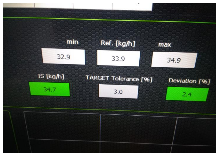
Slika 62 Podešenje protoka varijabilne geometrije [17]
