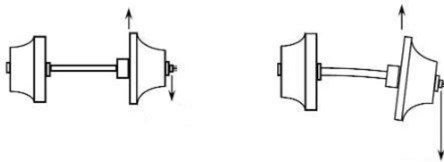
Slika 28 Nemogućnost balansiranja uslijed savinuća vratila [18]
