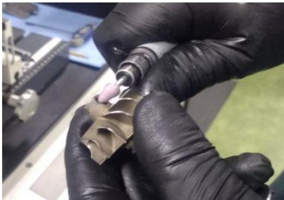
Slika 52 Uklanjanje mase - turbinski rotor [17]
