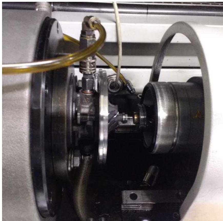
**Slika 56 Radna grupa pripremljena za balansiranje [17]**
