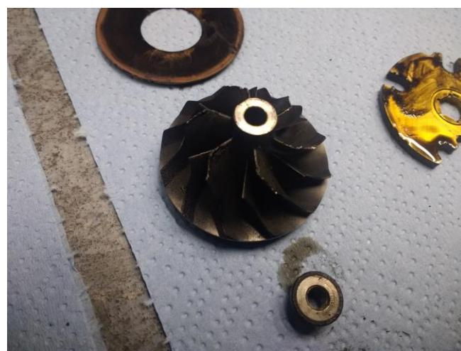
**Slika 43 Oštećen kompresijski rotor [17]**
