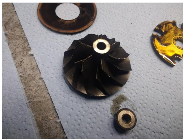
Slika 43 Oštećen kompresijski rotor [17]
