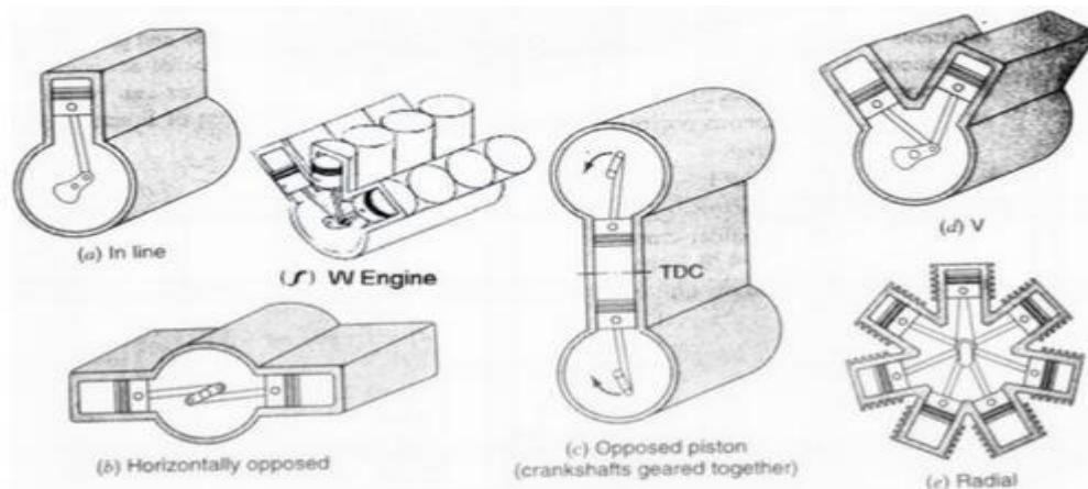
**Slika 2 Konfiguracija cilindara [3]**
