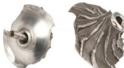
Pucanje komp. rotora uslijed prevelike brzine vrtnje
