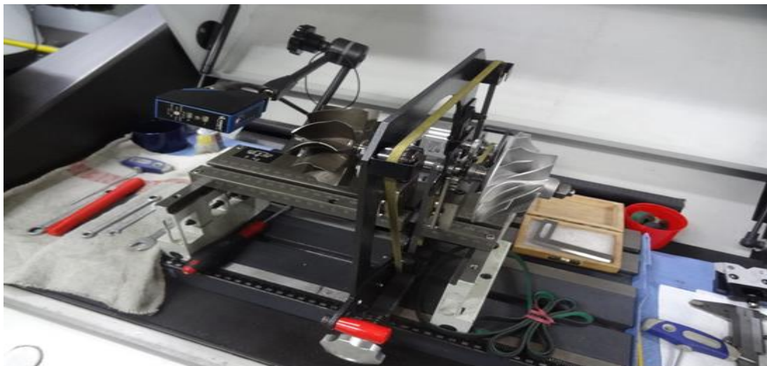
Slika 26 Niskobrzinsko dinamičko balansiranje [17]
