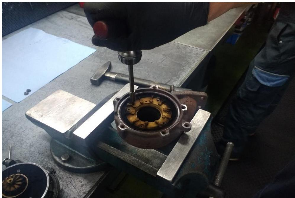
**Slika 39 Rastavljanje variabilne geometrije unutar turbinskog kućišta [17]**
