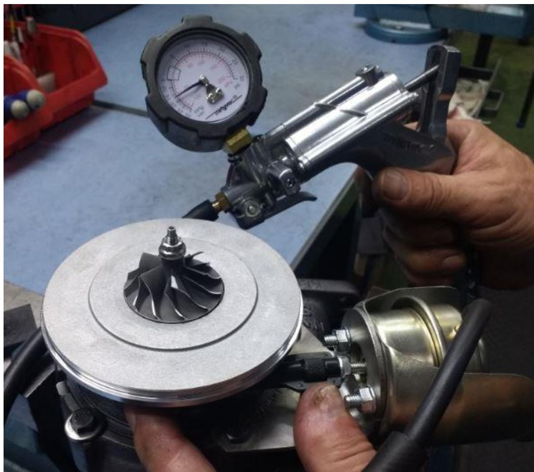
**Slika 64 Podešavanje vakuumskog aktuatora [17]**
