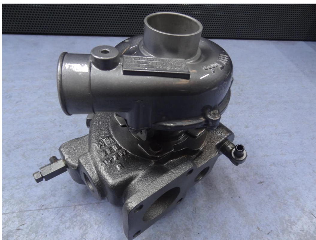
Slika 31 IHI RHB52YW - Yanmar brodski motor [17]
