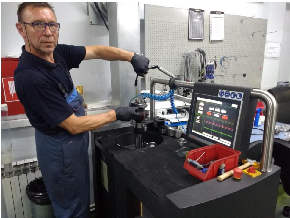
**Slika 38 Mjerenje protoka variabilne geometrije [17]**
