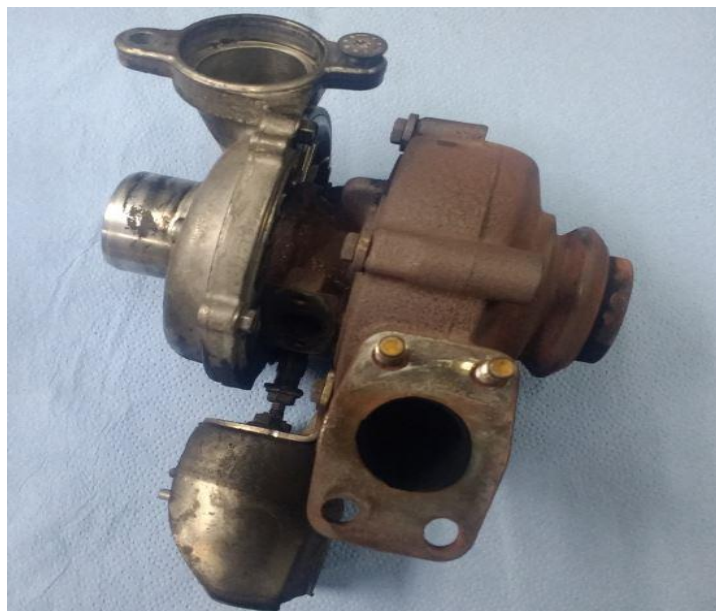
Slika 35 Neispravan sklop – turbopunjač [17]
