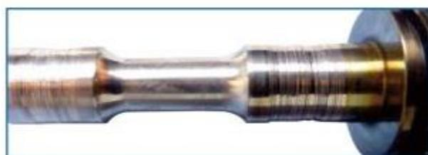
Oštećenje ležajnih mesta uslijed tvrdih čestica u ulju
