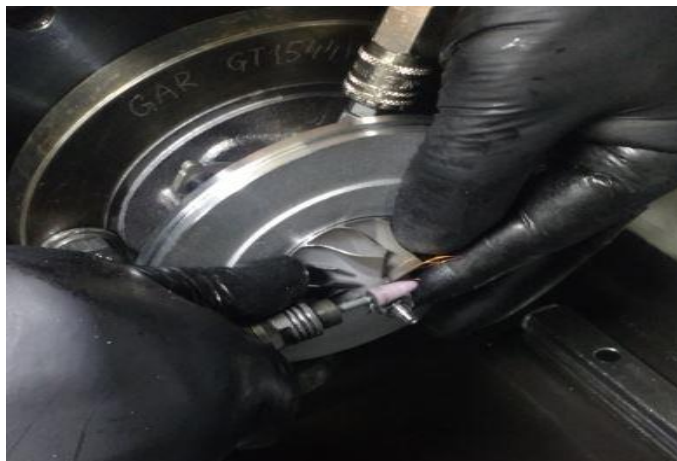
Slika 59 Uklanjanje viška mase na matici kompresijskog rotora [17]
