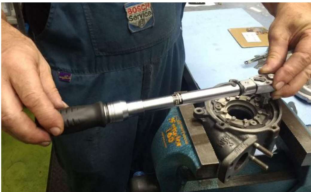
Slika 61 Pritezanje vijaka varijabilne geometrije moment ključem [17]
