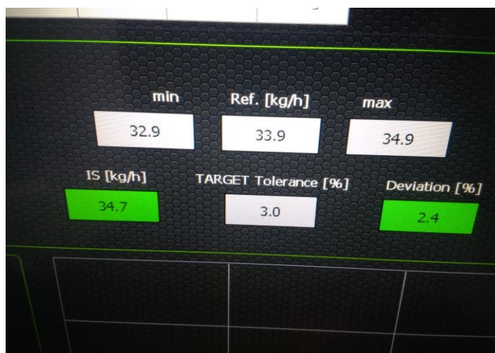
Slika 62 Podešenje protoka varijabilne geometrije [17]
