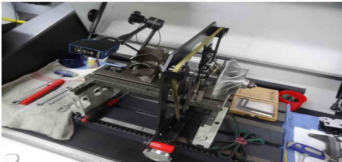
Slika 26 Niskobrzinsko dinamičko balansiranje [17]
