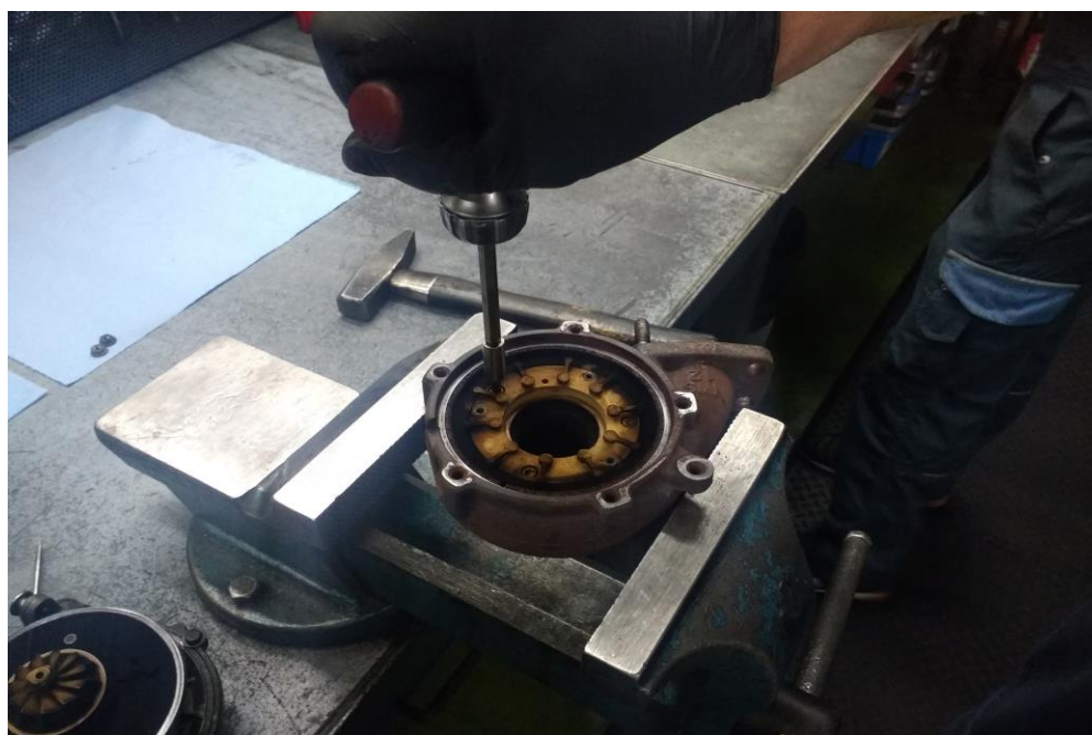
Slika 39 Rastavljanje varijabilne geometrije unutar turbinskog kućišta [17]
