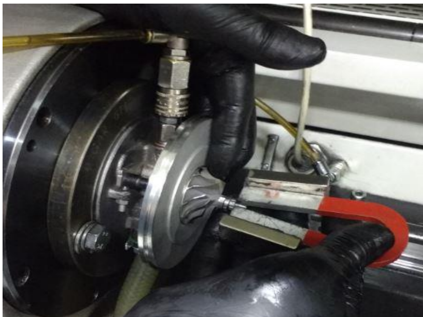
Slika 57 Magnetizacija matice kompresijskog rotora [17]
