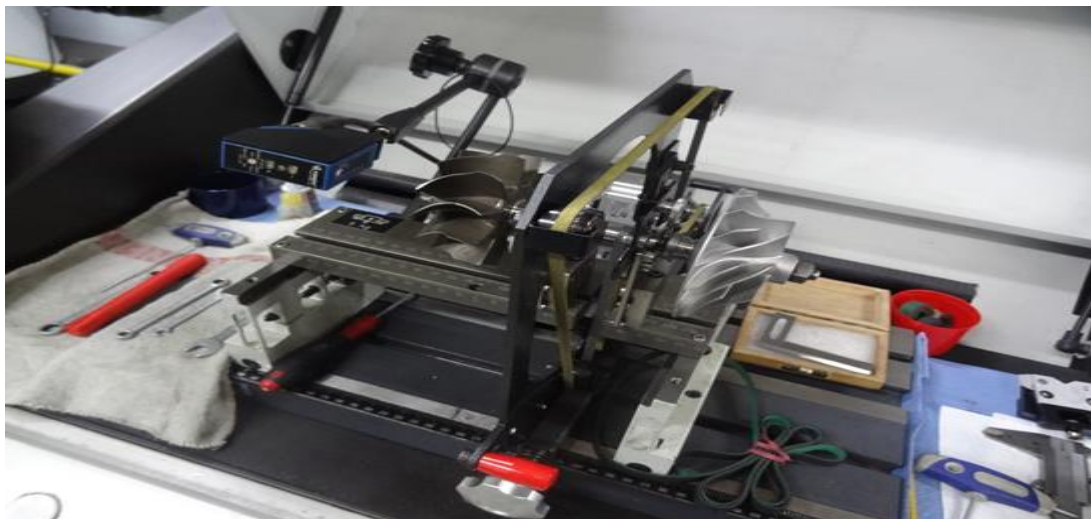
Slika 26 Niskobrzinsko dinamičko balansiranje [17]
