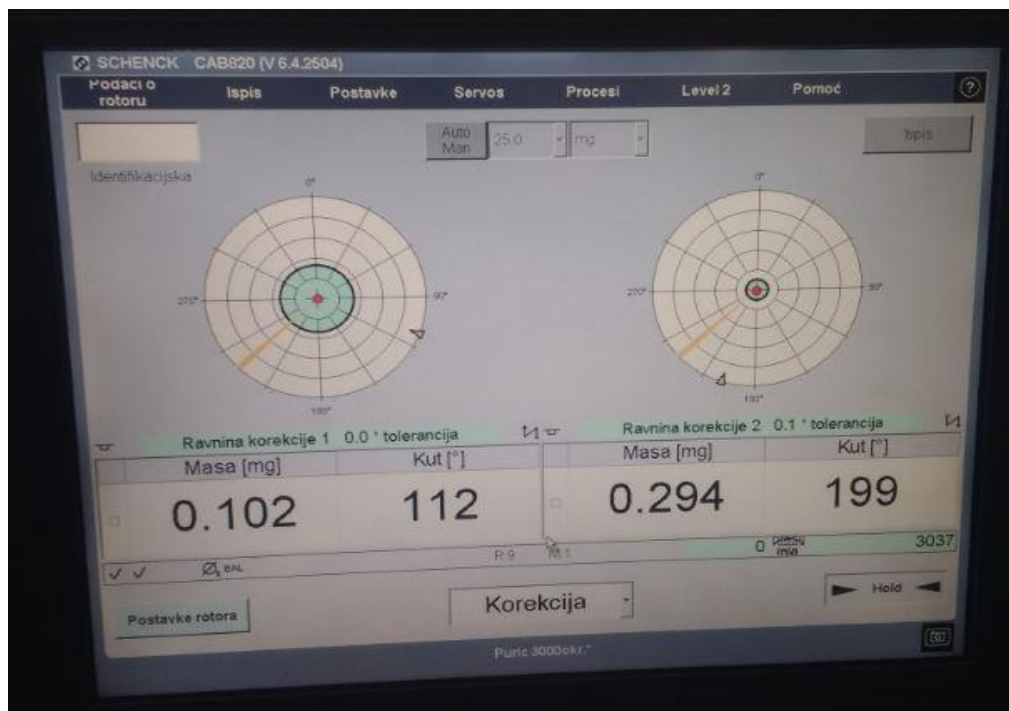
Slika 53 Finalni rezultat 1. balansiranja [17]
