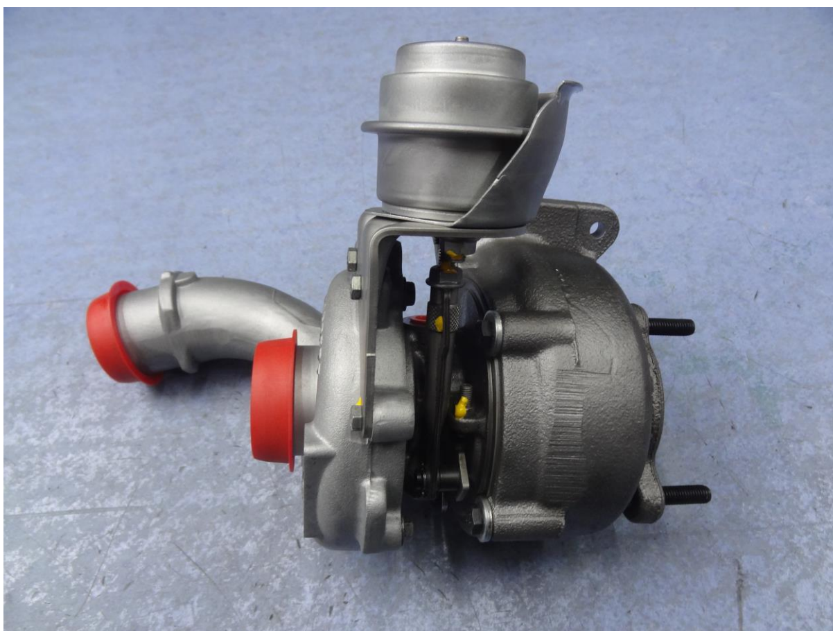
Slika 33 Garrett 708639 - 1.9 Dci 88kW, vakuumski upravljani VNT [17]
