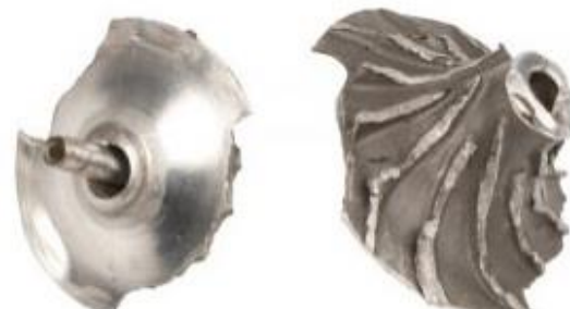
Pucanje komp. rotora uslijed prevelike brzine vrtnje
