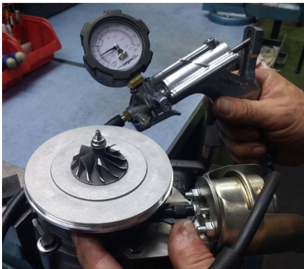
Slika 64 Podešavanje vakuumskog akuatora [17]
