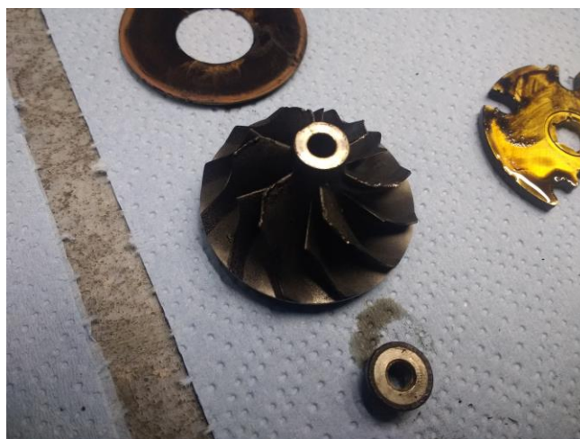
Slika 43 Oštećen kompresijski rotor [17]
