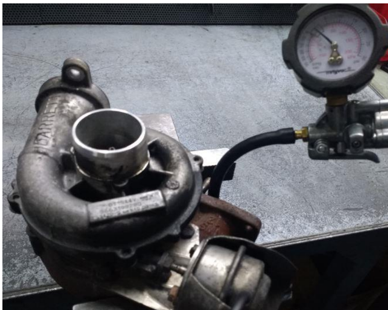
Slika 37 Vakuumska provjera podešenja aktuatora [17]
