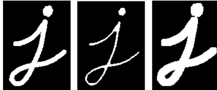
Slika 27: Primjer funkcija erode() i dilate() [30]
