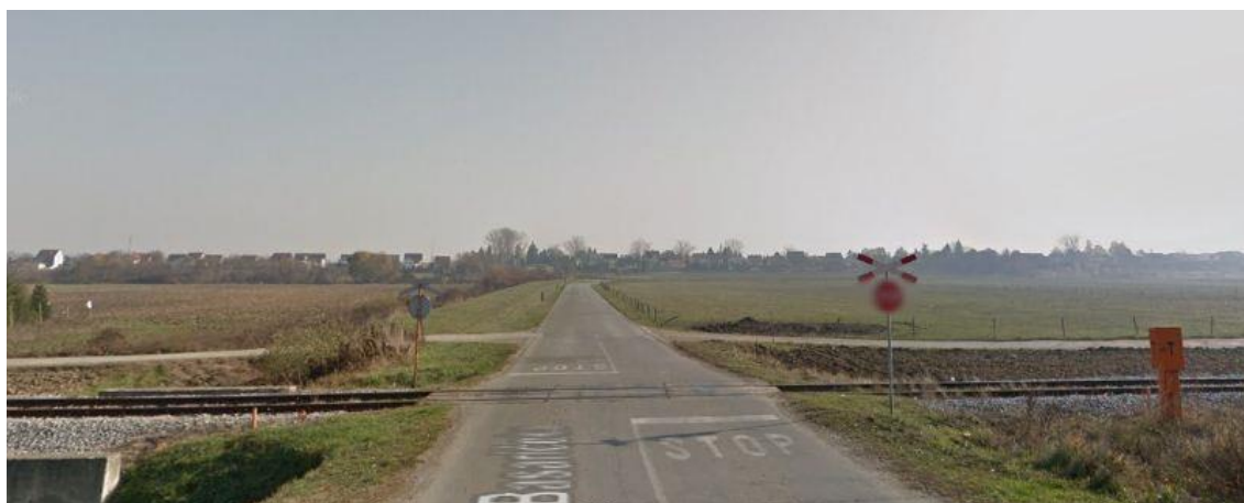
Slika 7. Predodžba pasivno osiguranog željezičko-cestovnog prijelaza [3]
