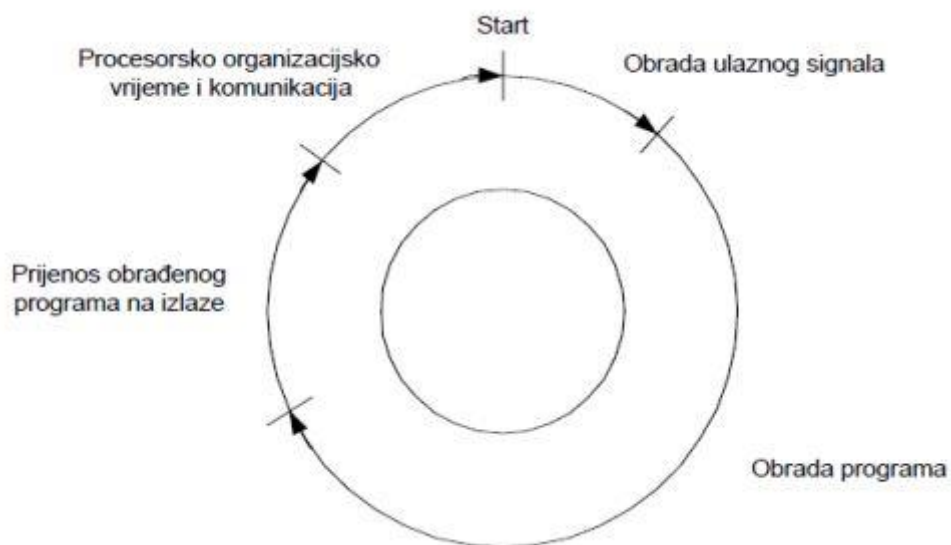
Slika 22. Predodžba principa rada PLC uređaja [34]
