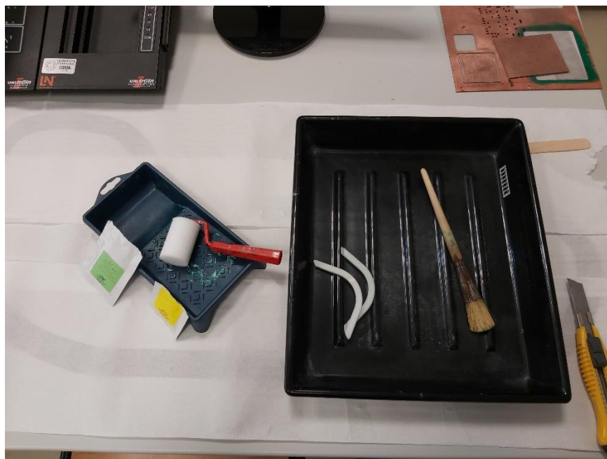
Slika 55. Pribor za stavljanje maske za lemljenje
