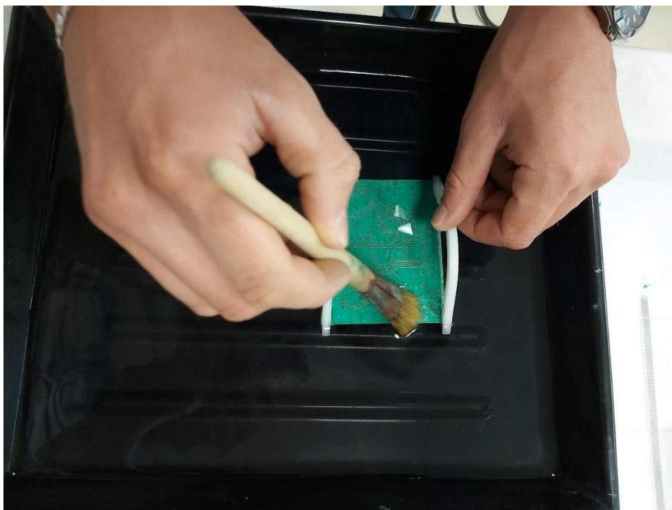
Slika 63. Skidanje sloja maske za lemljenje sa lemnih točaka
