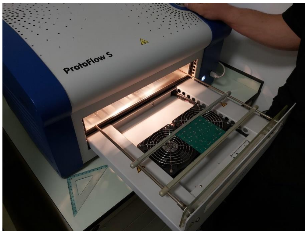
Slika 57. Položaj PCB pločice u ladici pećnice
