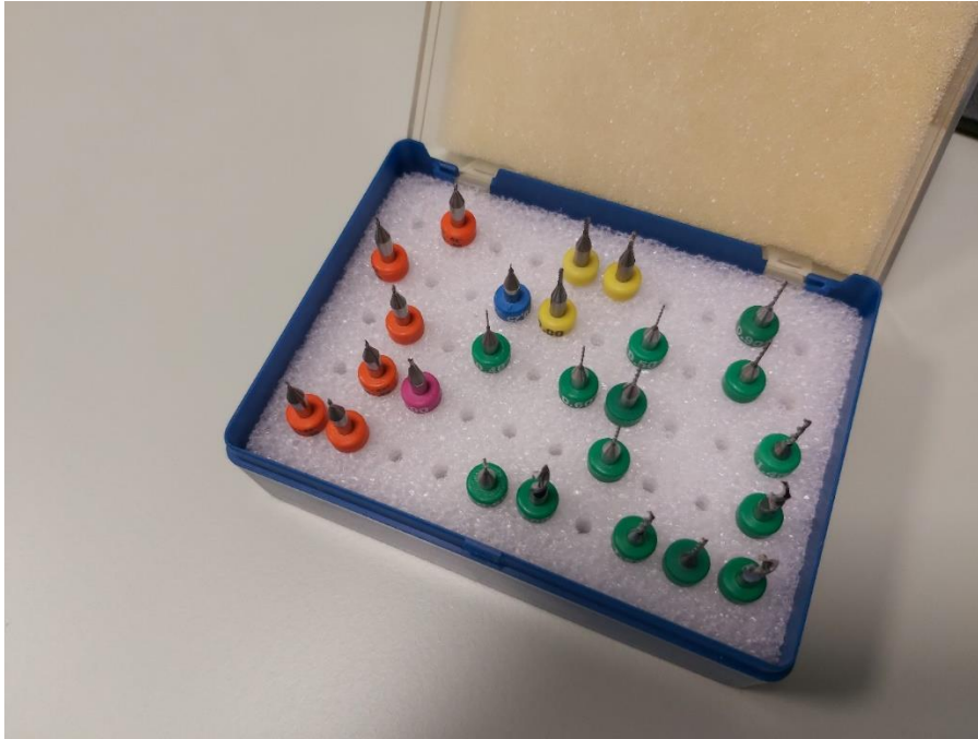
Slika 51. Svrkla za ProtoMat S63
