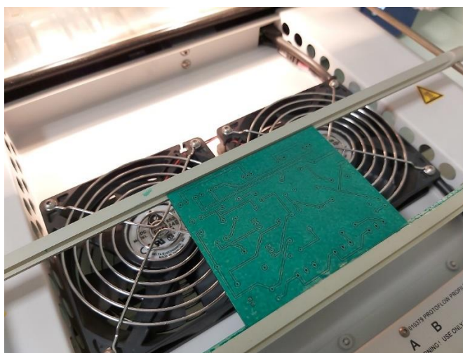
Slika 59. Hlađenje PCB pločice
