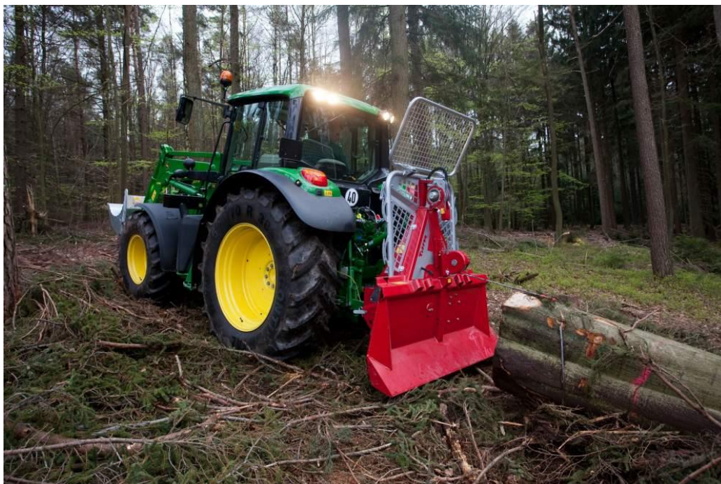
Slika 9. Adaptirani poljoprivredni traktor s vitlom (izvor: https://ru.all.biz/img/ru/catalog/2221671.jpeg )
