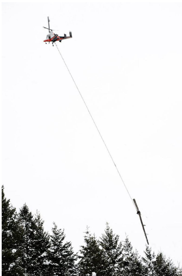
Slika 20. Iznošenje drva helikopterom
