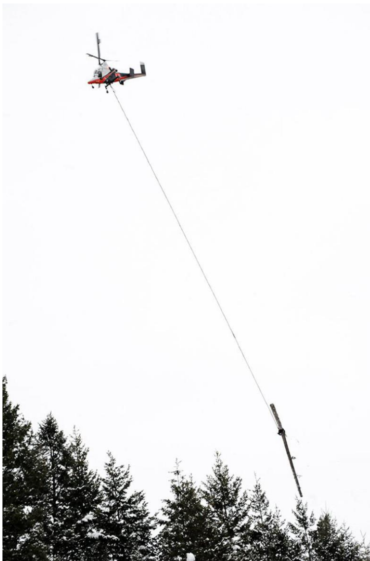
Slika 20. Iznošenje drva helikopterom
