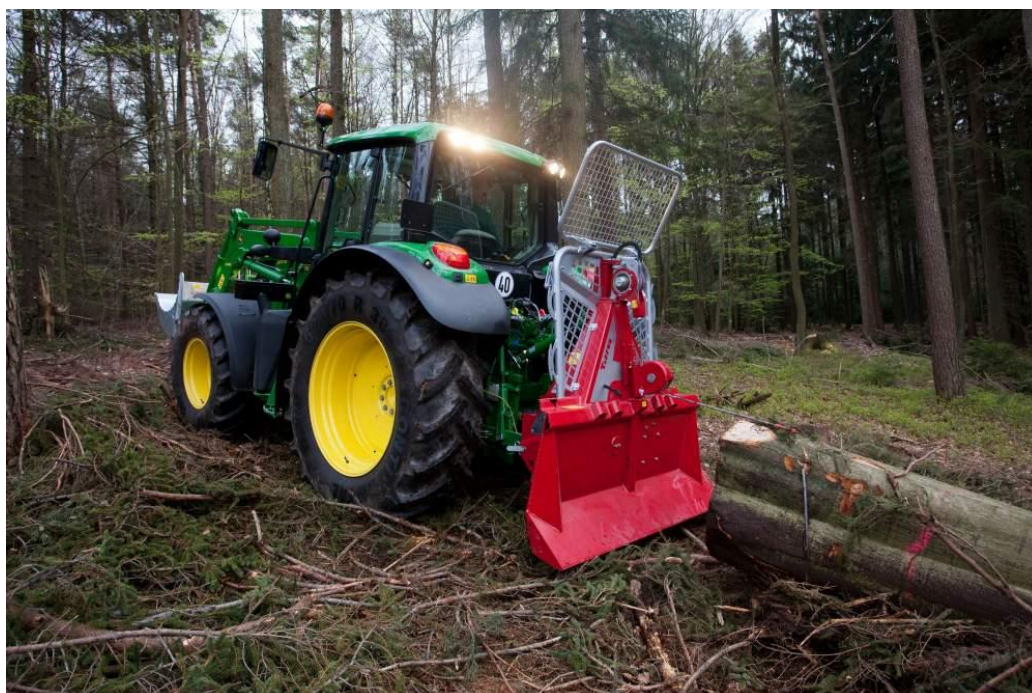
Slika 9. Adaptirani poljoprivredni traktor s vitlom (izvor: https://ru.all.biz/img/ru/catalog/2221671.jpeg )
