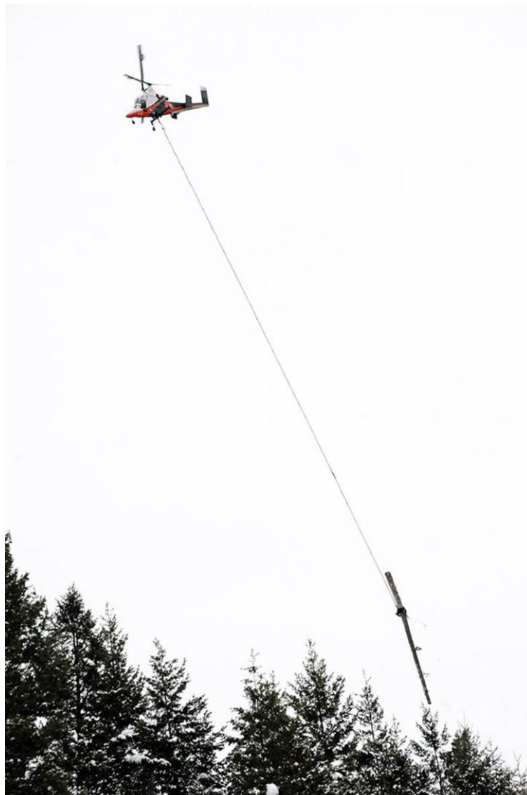
Slika 20. Iznošenje drva helikopterom
