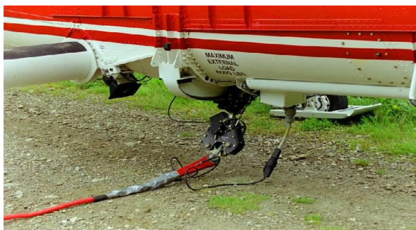
Slika 21. Dinamometar između kuke helikoptera i nosivog uža (izvor: Poršinsky, T., 2016: Iznošenje drva (šumske žičare, helikopter). Dostupno na: http://www.hkisdt.hr/podaci/2016/SU/prezentacije/zicara_komora_2.pdf )
