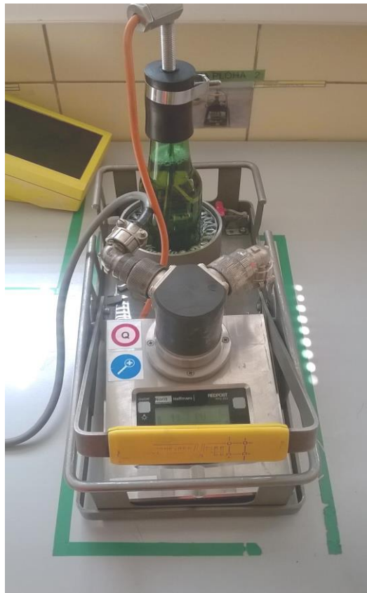
Slika 11. „Haffmans“ PU monitor
