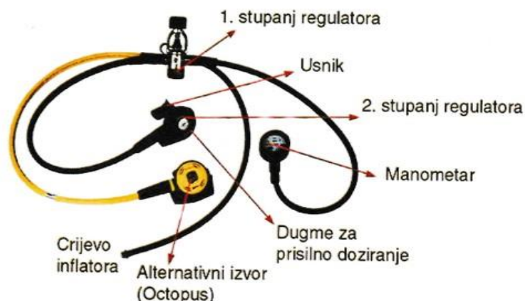
Sl. 10. Hidrostatski regulator [4]
