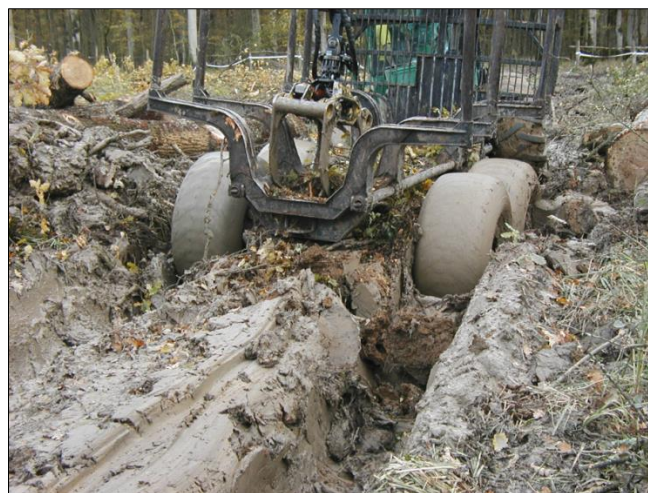
Slika 3: Oštećivanje tla uslijed pretovara [3]
