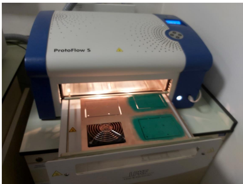
Slika 27. Postupak „pečenja“ pomoću ProtoFlow S pećnice
