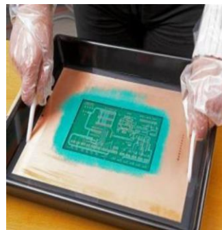
Slika 25 . Kemijski postupak skidanja foto osjetljivog laka sa pločice
