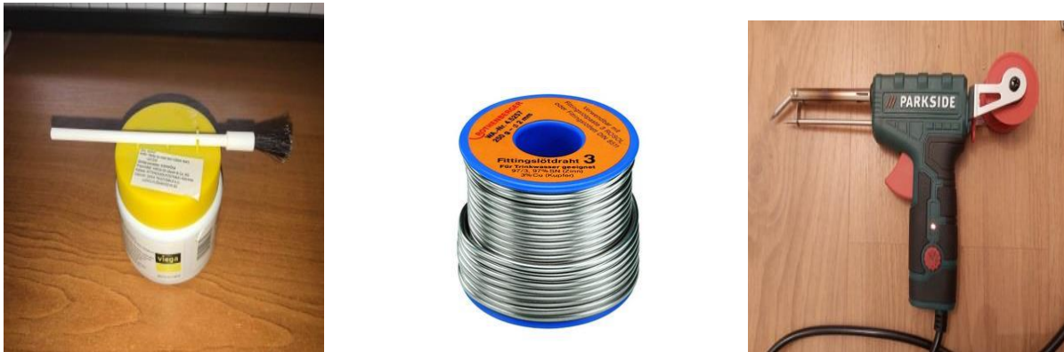
Slika 28. Pribor za lemljenje tiskane pločice
