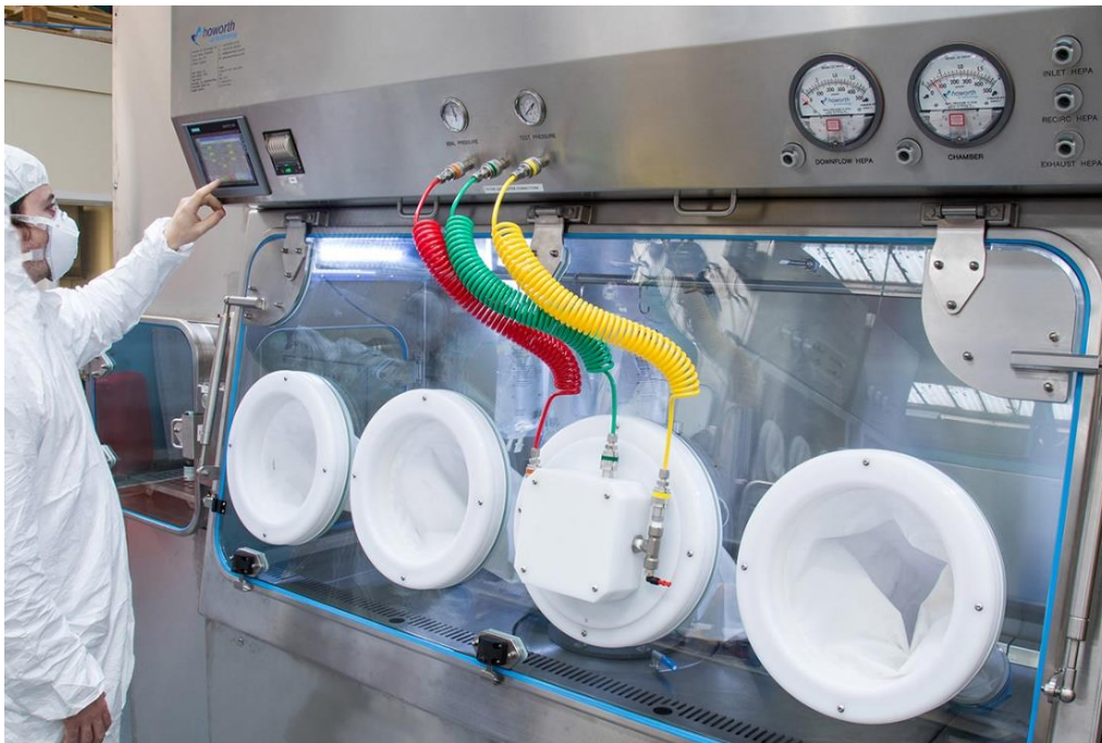
Slika 21. Prikaz testiranja nepropusnosti rukavica za rad operatera [15]
