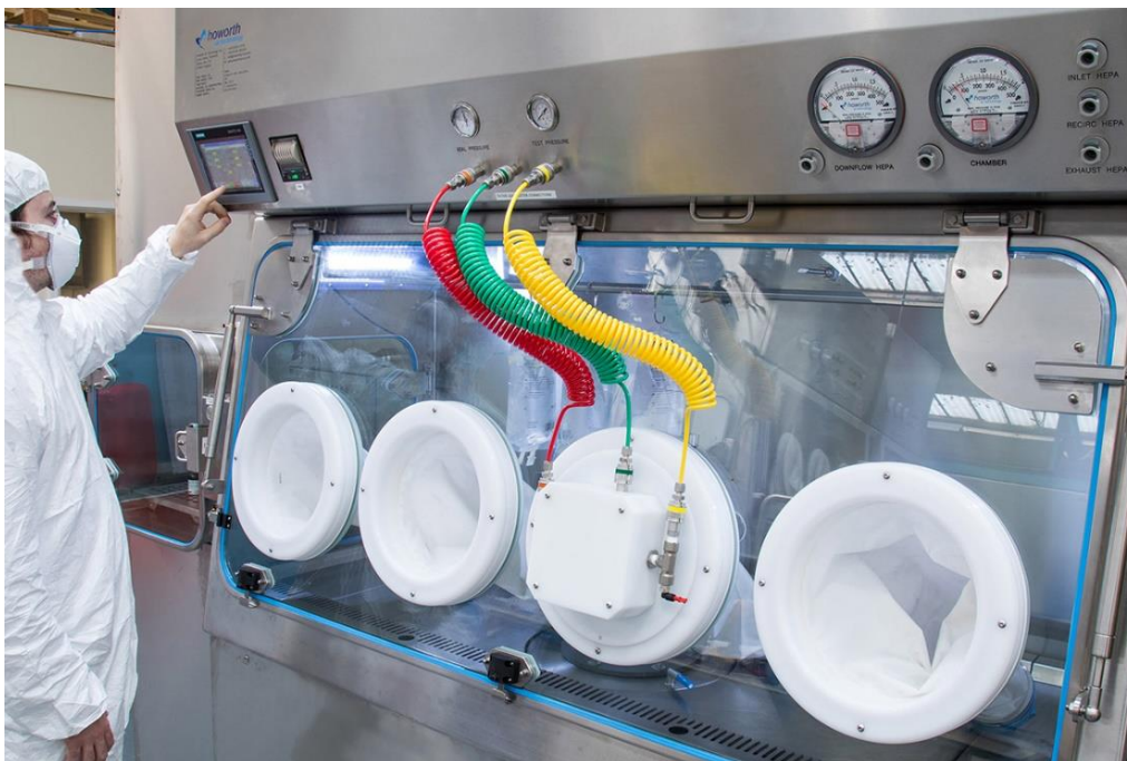
Slika 21. Prikaz testiranja nepropusnosti rukavica za rad operatera [15]
