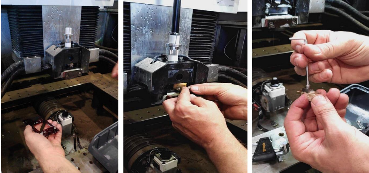
Slika 30: Demontaža gornjih kontaktnih dijelova
