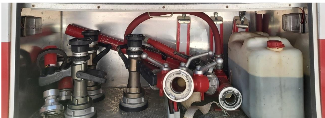
Sl.14. Međumješalica, mlaznice, pjenilo navalnog vatrogasnog vozila DVD Beretincec [9]
