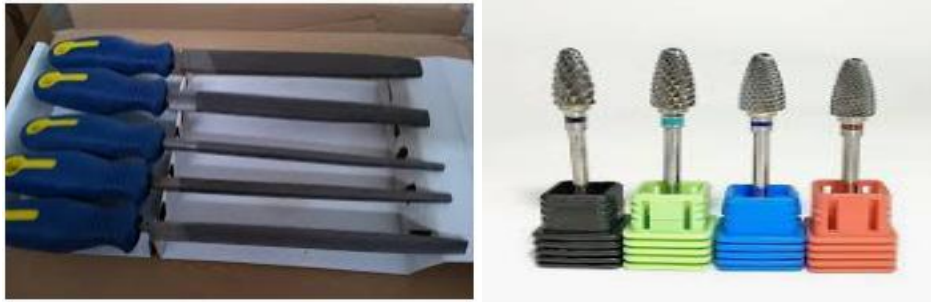
Slika 7. Set ručnih turpija i nastavaka za turpije na električni pogon[5]
