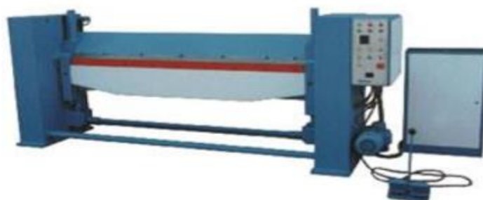
Slika 31. Valjak za obradu lima s fotoćelijama[2]
