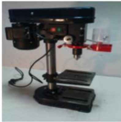
Slika 32. Stupna bušilica sa automatskom zaštitnom opremom[7]
