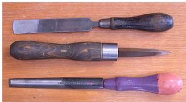
Slika 8. Tri vrste grecala[5]
