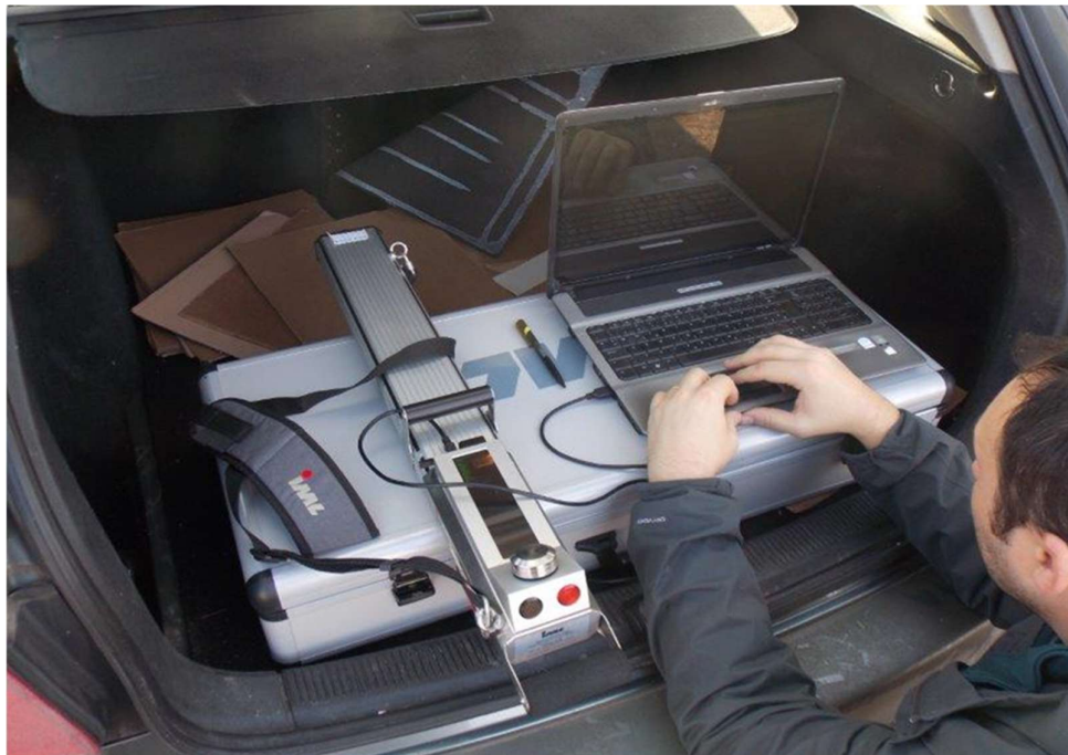
Slika br. 19 Obrada podataka dobivena metodom rezistografije
