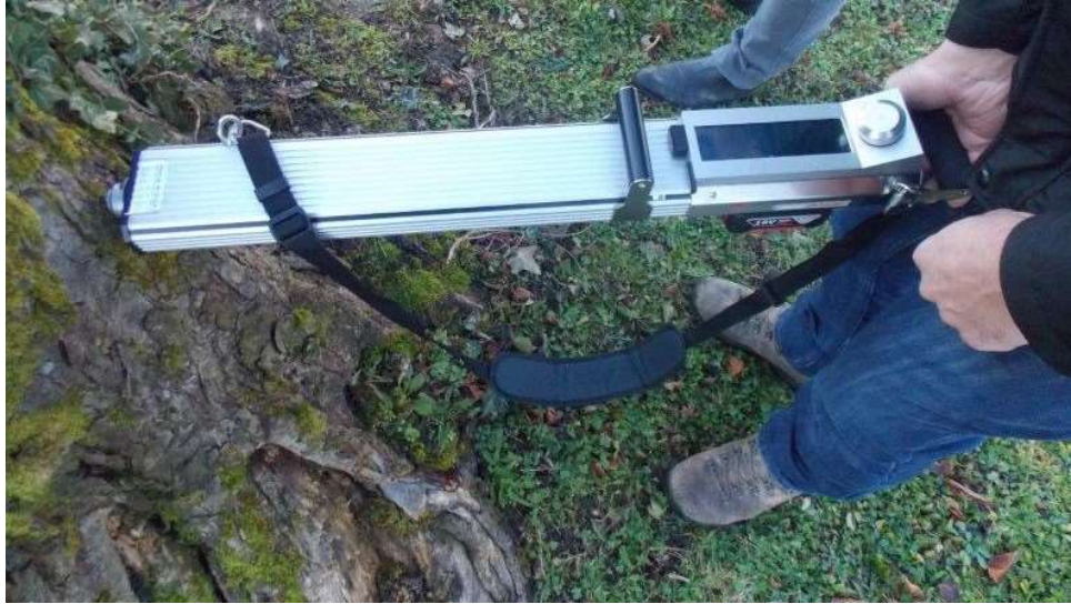
Slika br. 12 Mikro bušenje rezistografom
