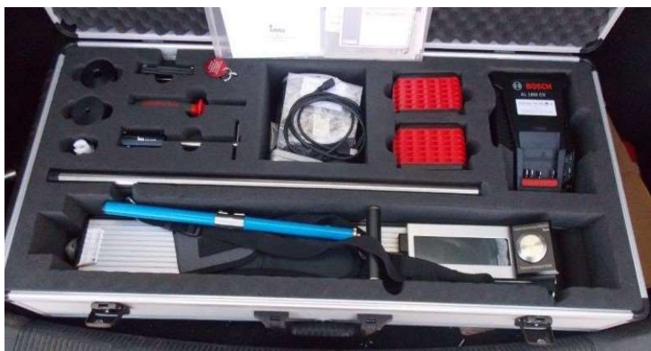
Slika br. 4 Rezistograf IML - RESI PD 400
