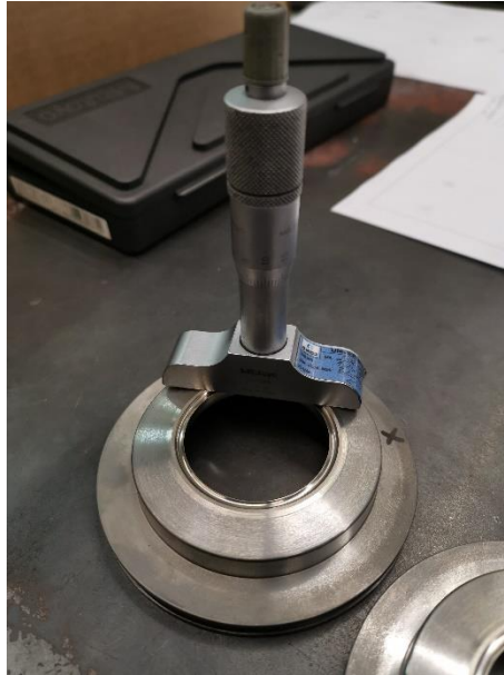
Slika 63: Dimenzijska kontrola dubine fazone prstena.
