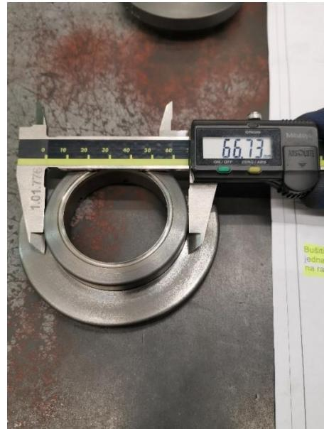
**Slika 60:** Dimenzijska kontrola vanjskog promjera prstena.
