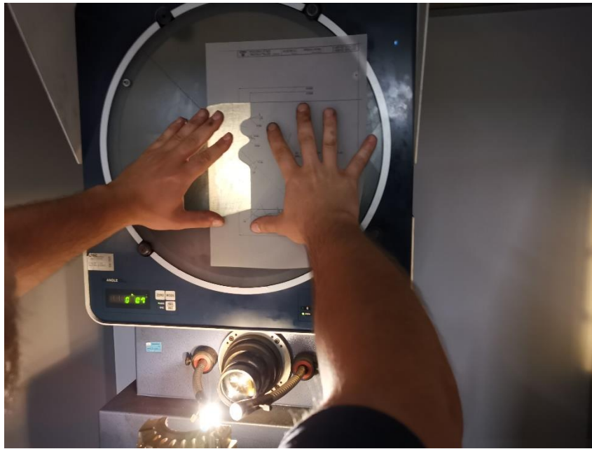
Slika 59: Kontrola grla na projektoru.
