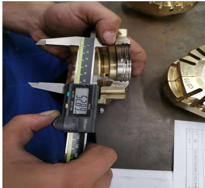
**Slika 56:** Kontrola promjera fazone pomičnim mikrometrom.
