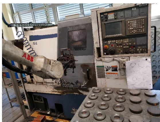
Slika 42: Tokarenje prstena do metalizacije.
