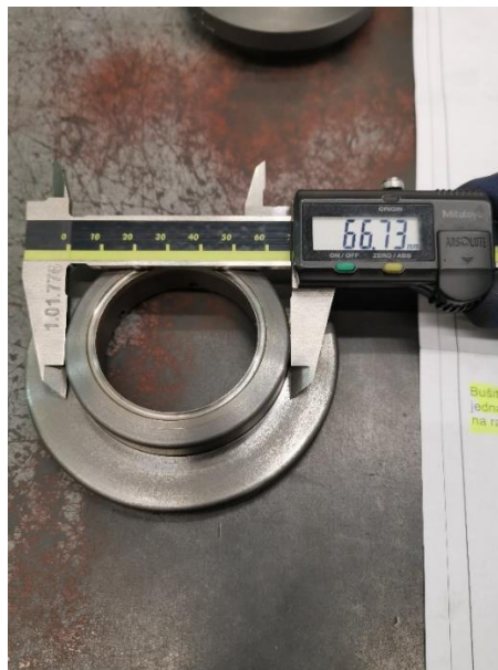
Slika 60: Dimenzijska kontrola vanjskog promjera prstena.
