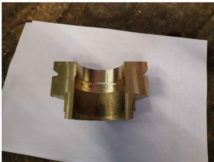
Slika 30: Glodanje prije metalizacije.
