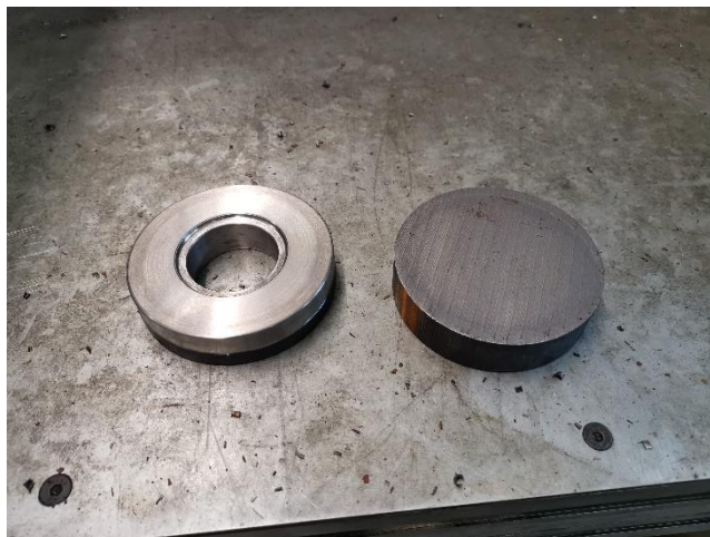
Slika 43: Tokarenje prstena do metalizacije.
