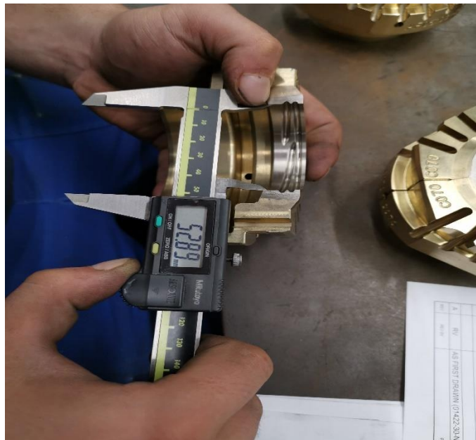
Slika 56: Kontrola promjera fazone pomičnim mikrometrom.
