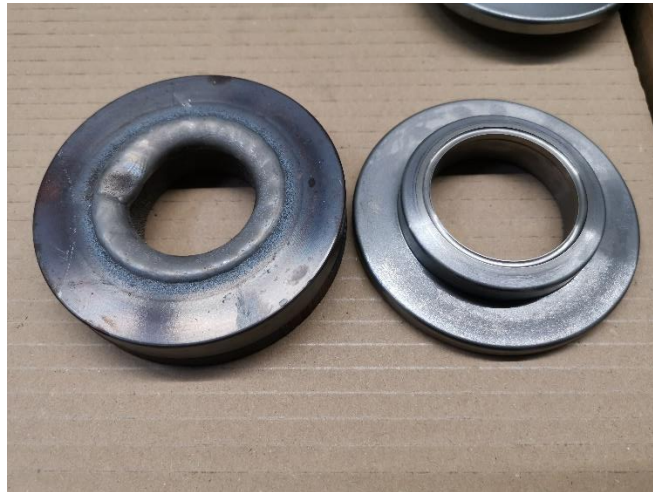
Slika 47: Tokarenje prstena po metalizaciji.
