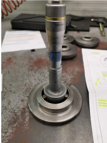
Slika 61: Dimenzijska kontrola unutarnjeg promjera prstena.
