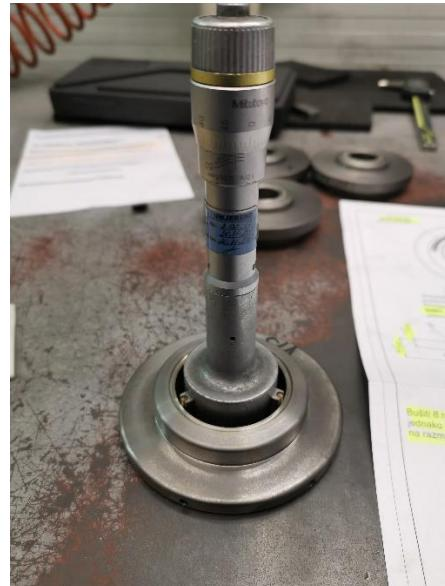
**Slika 61:** Dimenzijska kontrola unutarnjeg promjera prstena.
