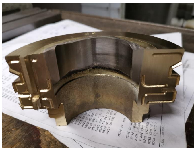
Slika 36: Glodanje po metalizaciji.
