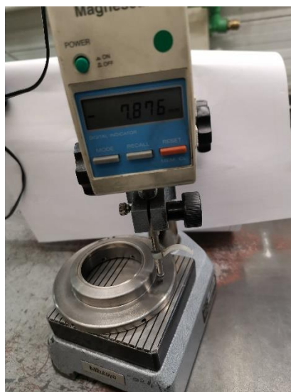
Slika 62: Dimenzijska kontrola visine prstena.
