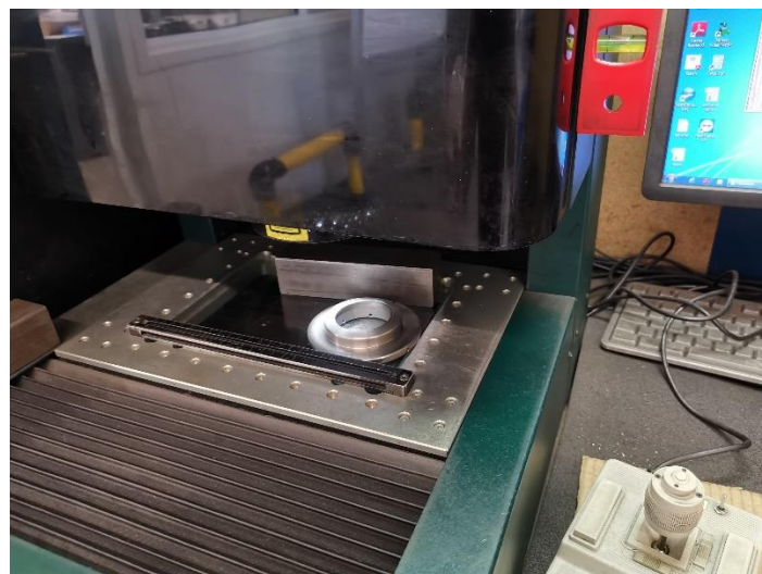
Slika 64: Dimenzijska kontrola promjera fazone prstena.
