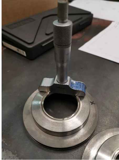
Slika 63: Dimenzijska kontrola dubine fazone prstena.
