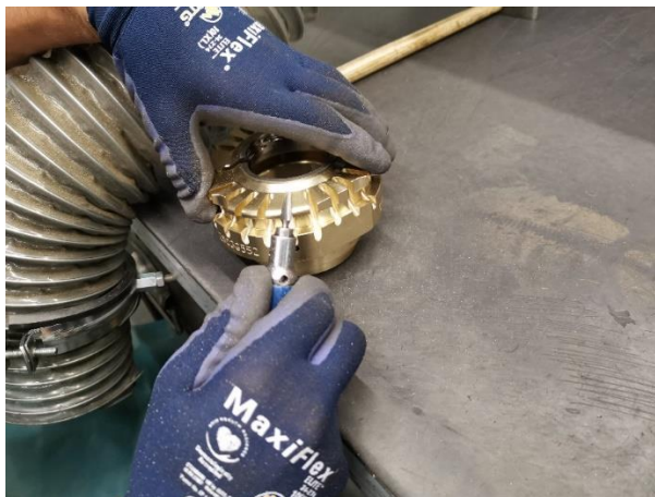
Slika 41: Skidanje oštih rubova i dorada navoja.
