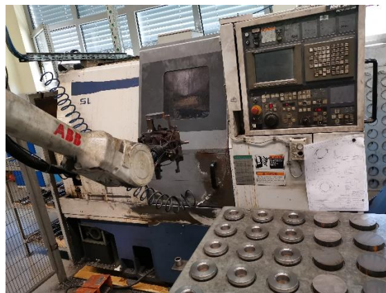
Slika 42: Tokarenje prstena do metalizacije.
