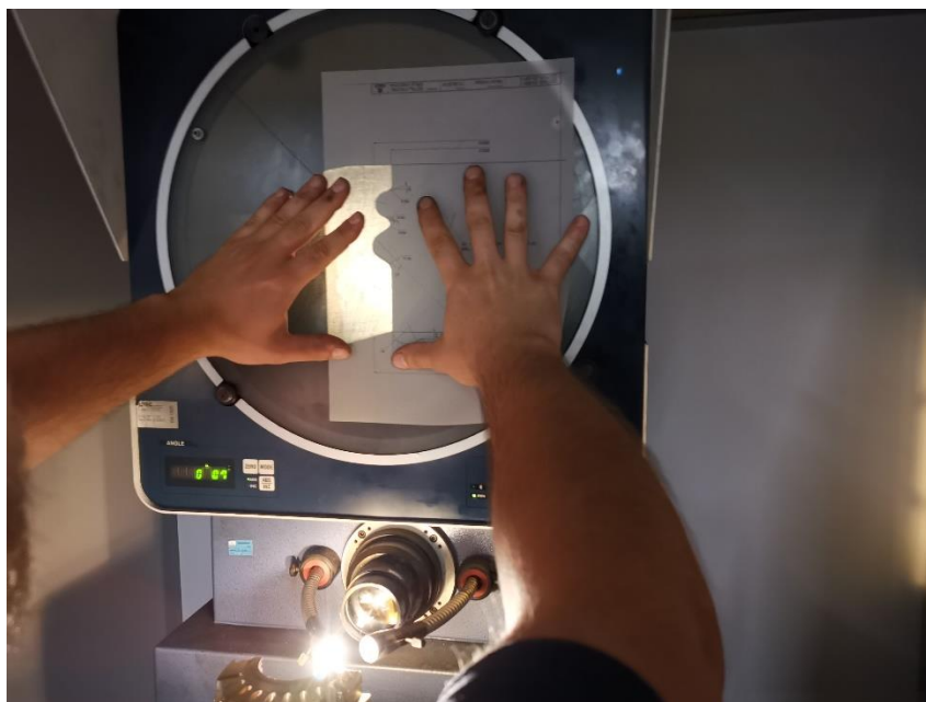
Slika 59: Kontrola grla na projektoru.
