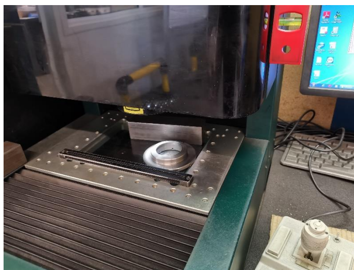
Slika 64: Dimenzijska kontrola promjera fazone prstena.
