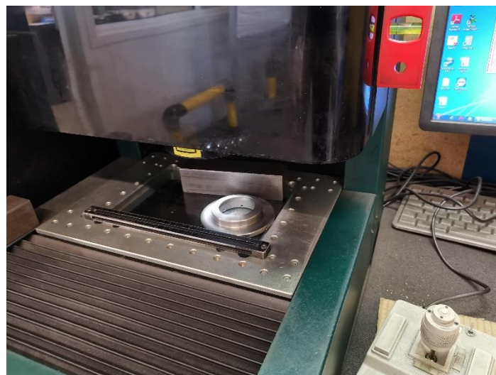
Slika 64: Dimenzijska kontrola promjera fazone prstena.
