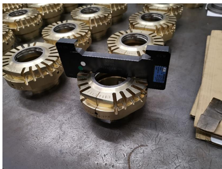
Slika 55: Kontrola visine prizme na grlu.
