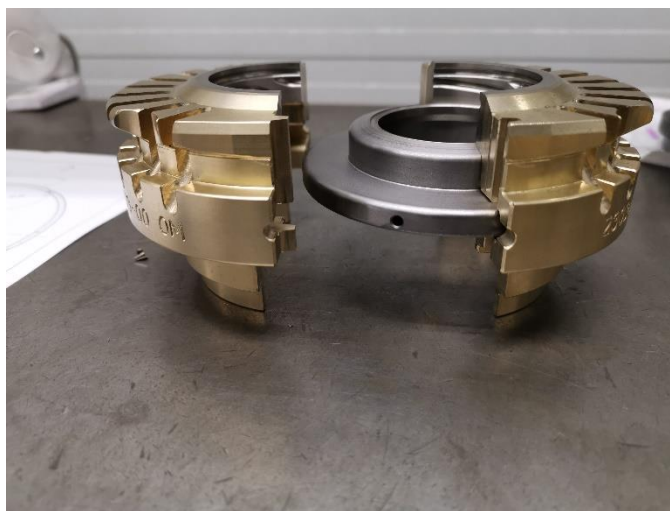
Slika 66: Kontrola sklopa grlo-prsten.
