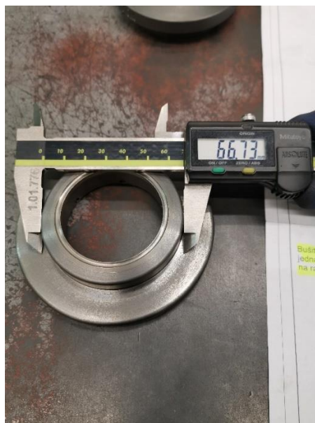
Slika 60: Dimenzijska kontrola vanjskog promjera prstena.
