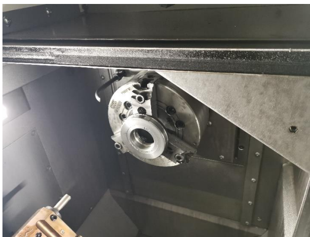
Slika 46: Tokarenje prstena po metalizaciji.
