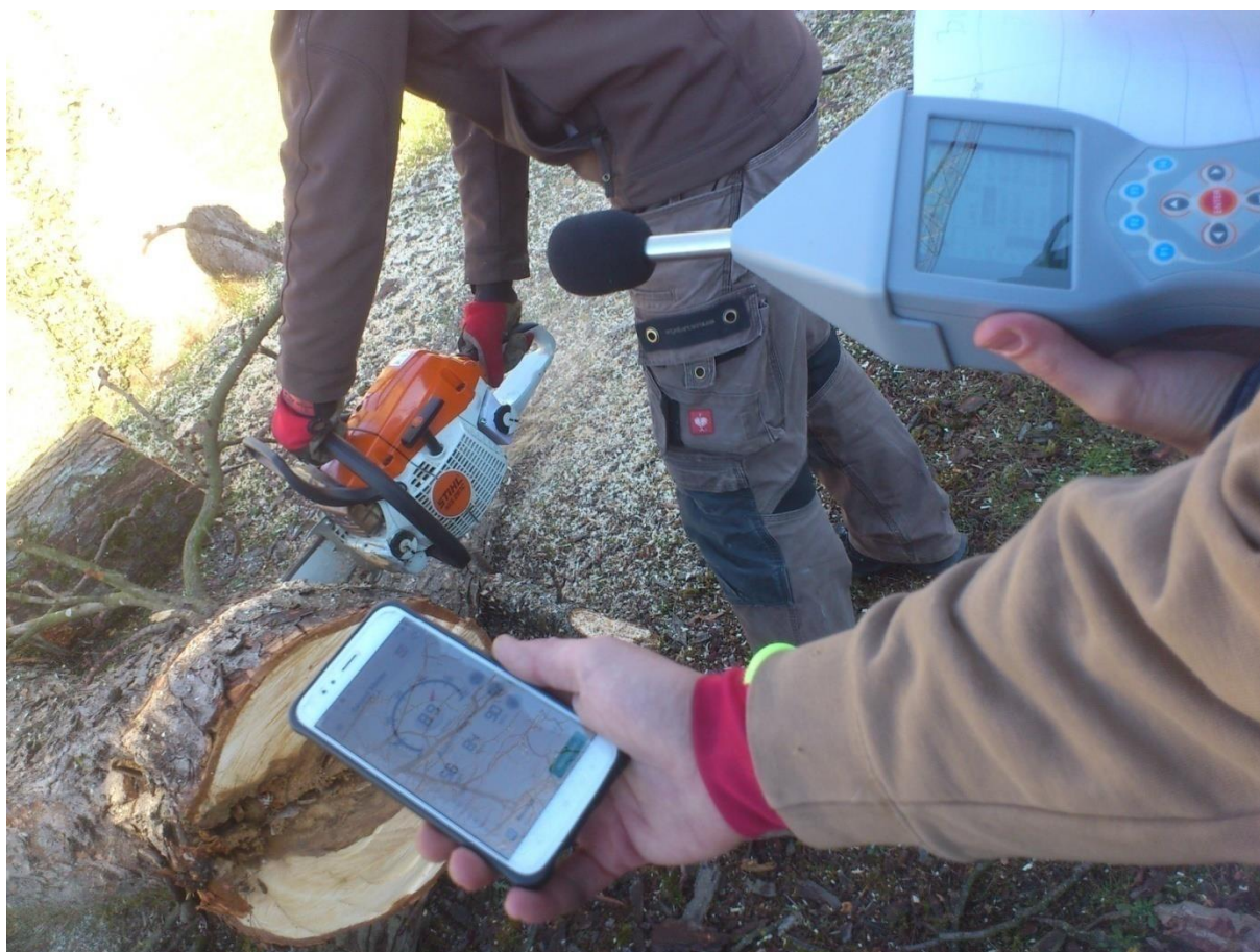
Slika 37 Mjerenje razine buke pomoću bukomjera i mobilne aplikacije za mjerenje buke [10]
