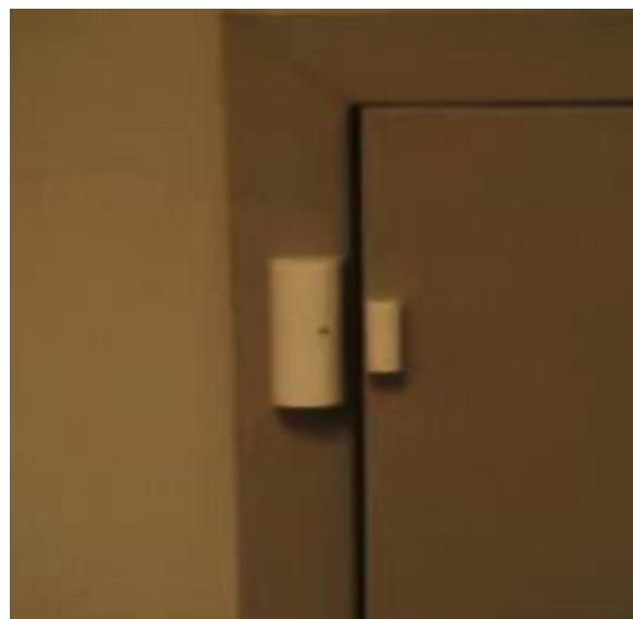
Slika 5. Predodžba bežičnog magnetskog prekidača na vratima. [7]
