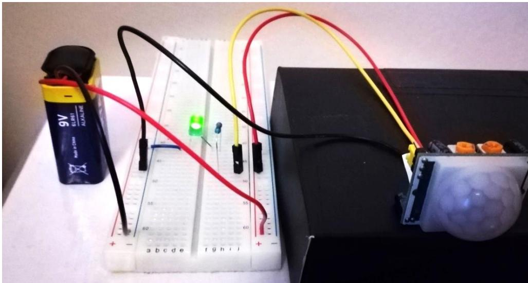
Slika 21. Predodžba povezivanja PIR senzora sa LED diodom.
