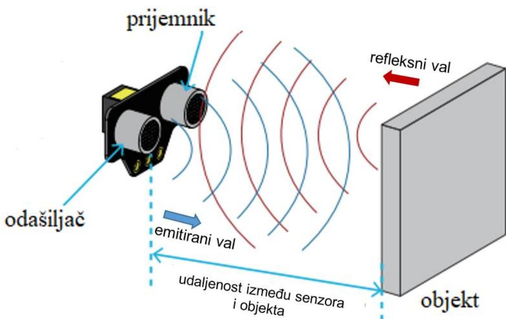
Slika 7. Predodžba rada ultrazvučnog detektora pokreta.
