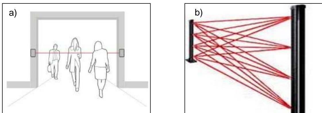
Slika 11. Predodžba primjene aktivnog IC senzora. [14]; [15]
