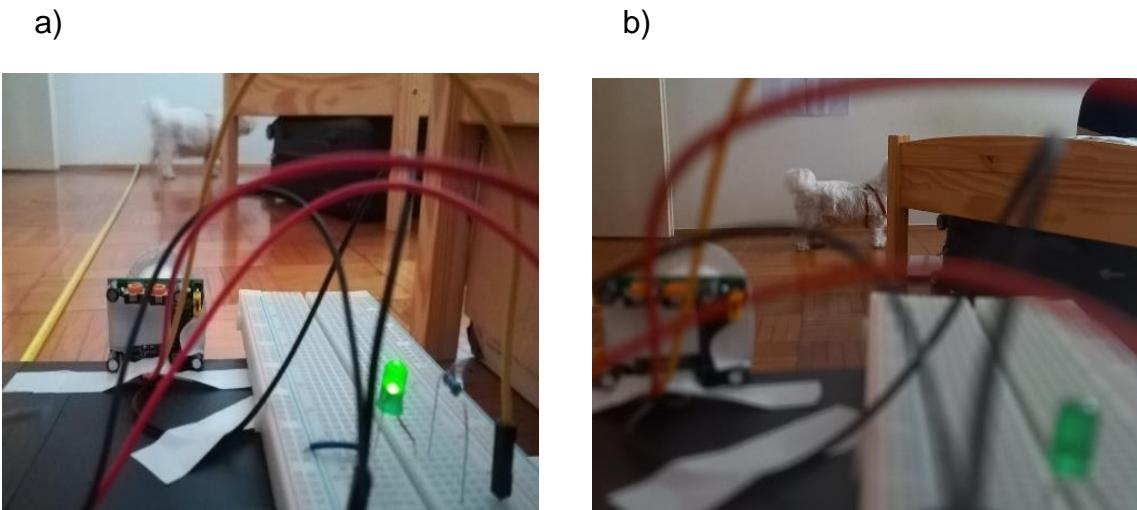
Slika 24. Predodžba reagiranja PIR senzora na visini: a) 0,2m; b) 0,5 m
