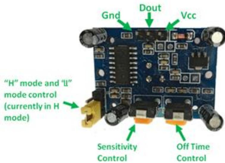
Slika 15. Predodžba poleđine PIR senzora.
