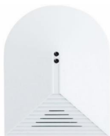
Slika 1. Predodžba akustičnog detektora loma stakla.
