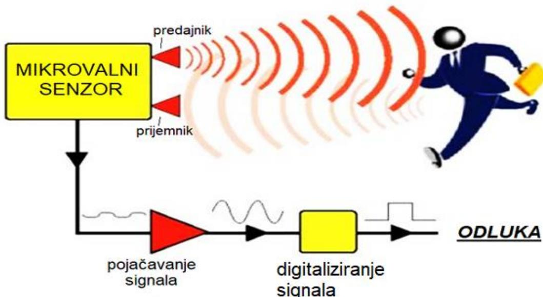
Slika 8. Blok dijagram rada mikrovalnog detektora pokreta.
