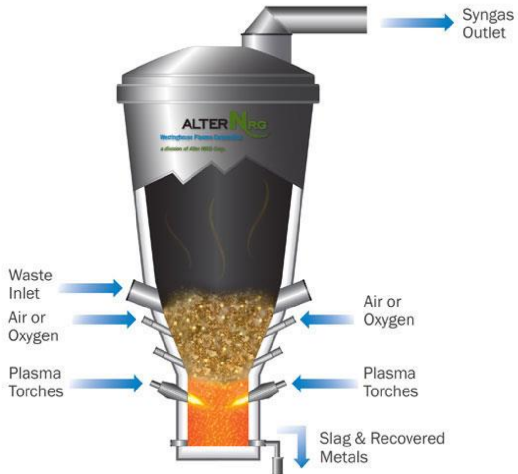
Slika 7 Shema plazma rasplinjača (ANONIMOUS 10, 2019.)
