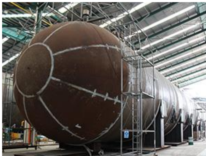
Slika 4. Radionička izrada spremnika Izvor: https://www.petrofac.com/petrofacts/bullets/
