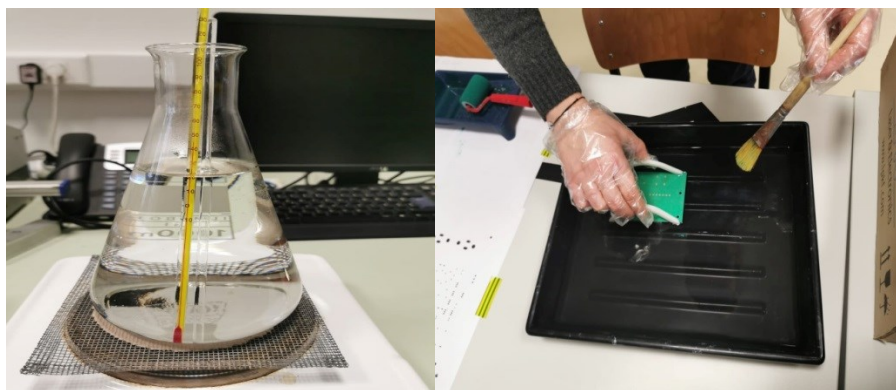
Slika 20: Zagrijavanje vode i čišćenje preostale maske na pločici [20]
