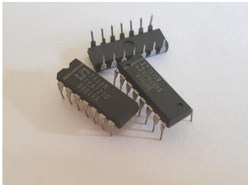
Slika 42: DIP kućište
