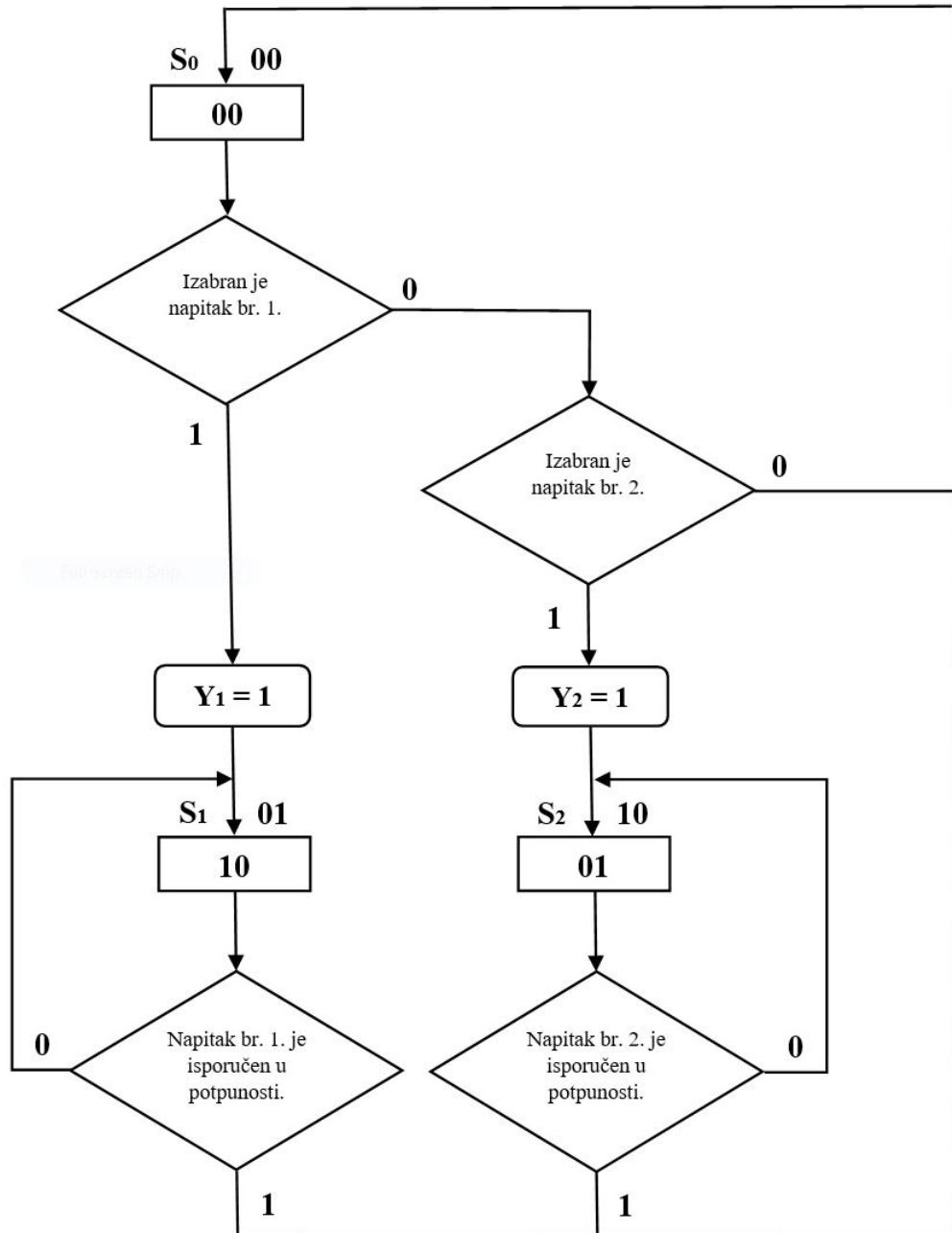
Slika 28: Dijagram toka pojednostavljenog samoposlužnog automata
