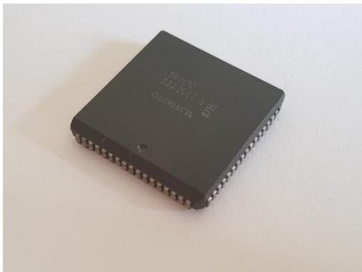
*Slika 44: Kućište za površinsku montažu*
