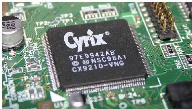
Slika 223: Plosnato kućište
