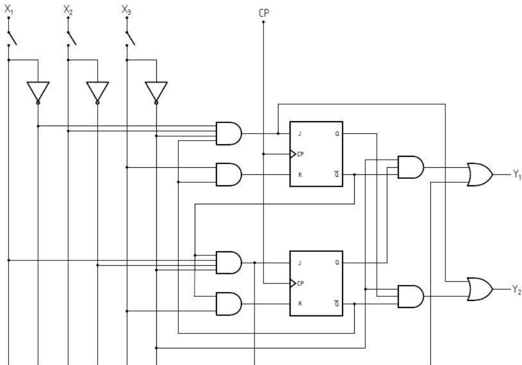
Slika 32: Logička shema automata 3-2 izvedena s JK-bistabilom
