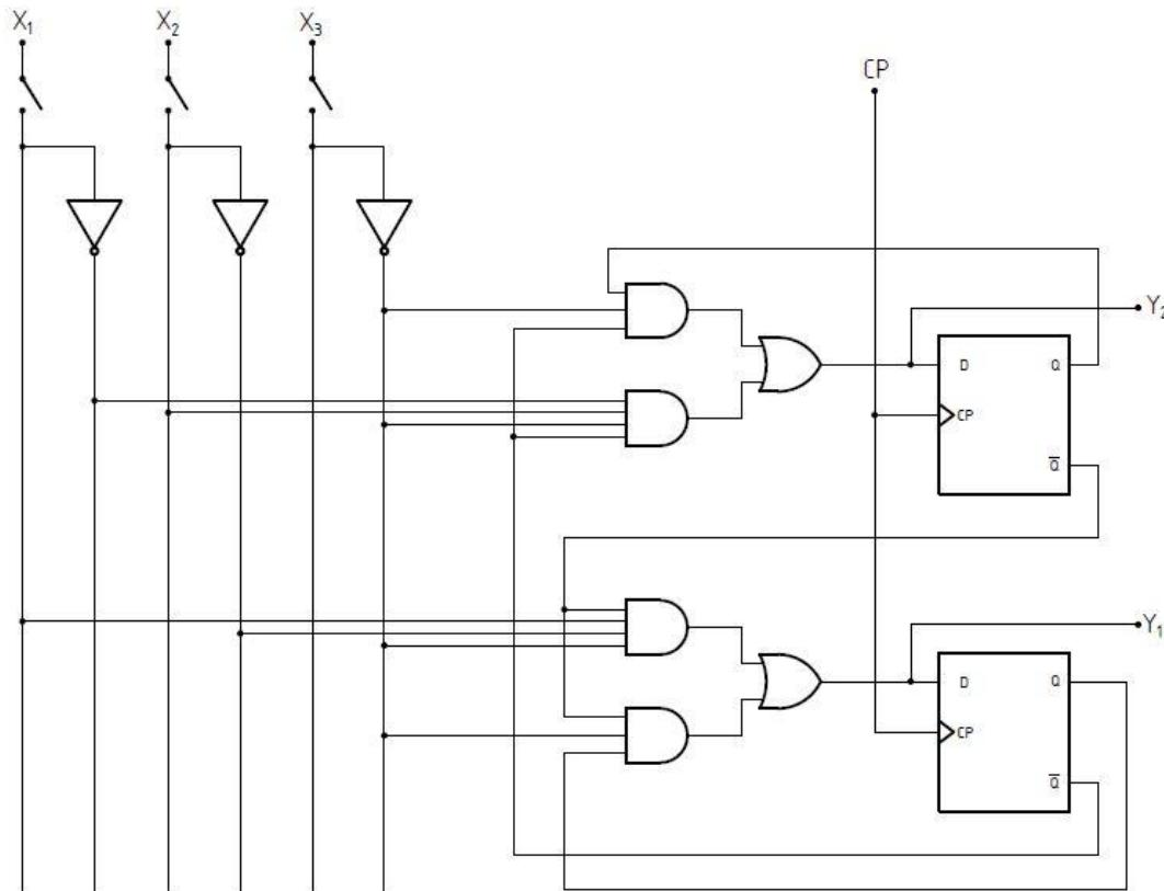
Slika 33: Logička shema automata 3-2 izvedena s D-bistabilom
