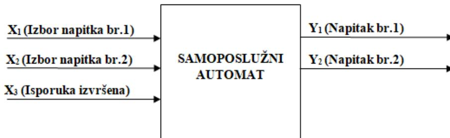
Slika 29: Pojednostavljeni automat za napitke
