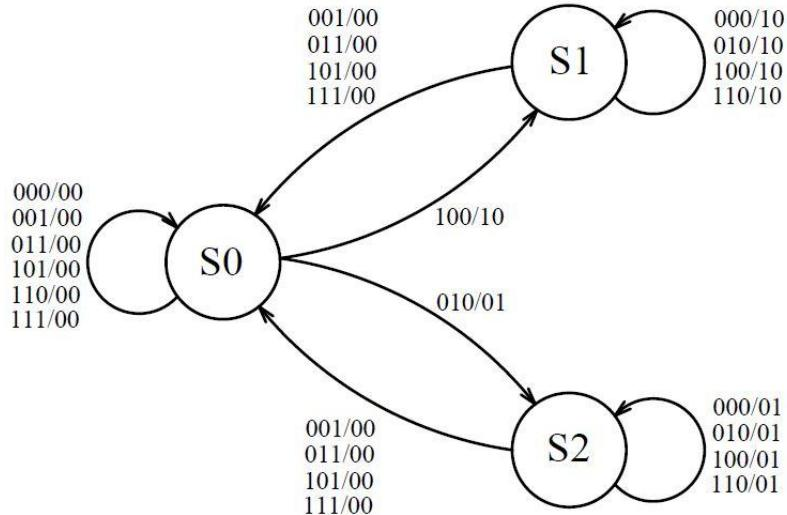
Slika 30: Dijagram stanja pojednostavljenog samoposlužnog automata
