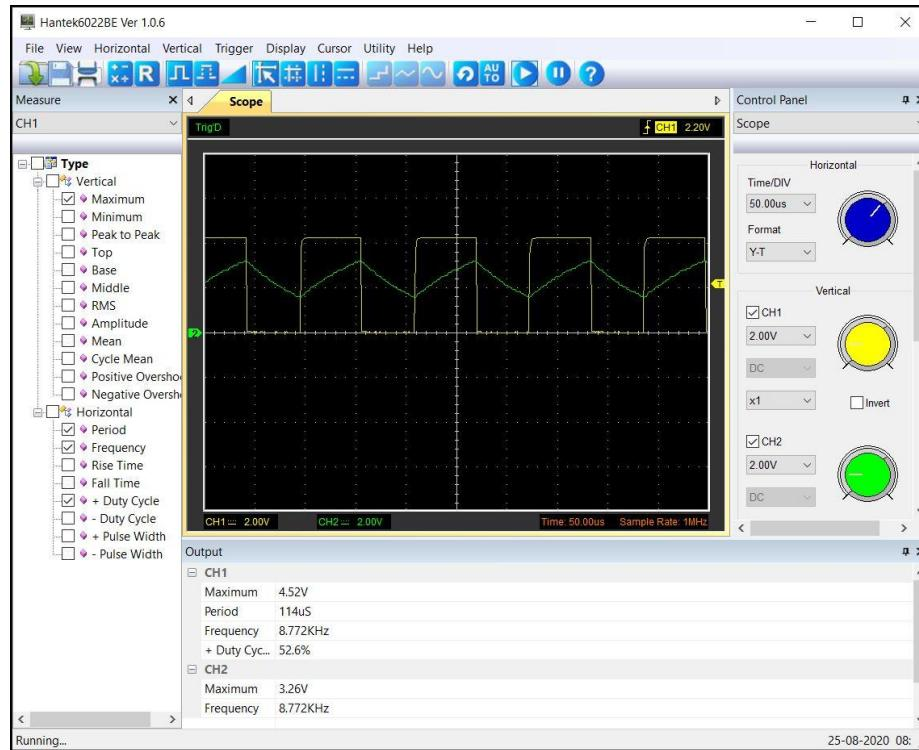
Slika 49: Mjerjenje frekvencije korištenjem digitalnog osciloskopa
