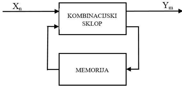
Slika 25: Blok-shema sekvencijskog sustava
