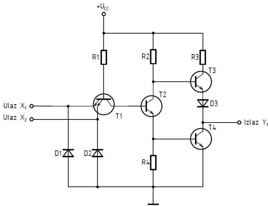
Slika 39: Dvoulazni NAND sklop izведен s bipolarnim tranzistorima - TTL
