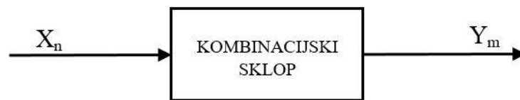
Slika 24: Blok-shema kombinajskog sklopa
