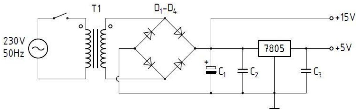
Slika 51: Shema sklopa sustava napajanja
