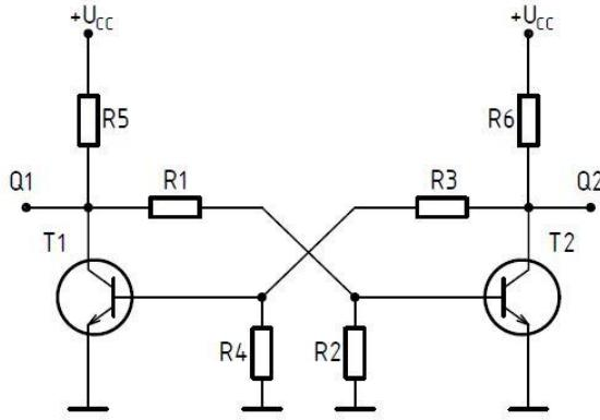
Slika 40: Shema bistabila izvedenog uz pomoć bipolarnih tranzistora
