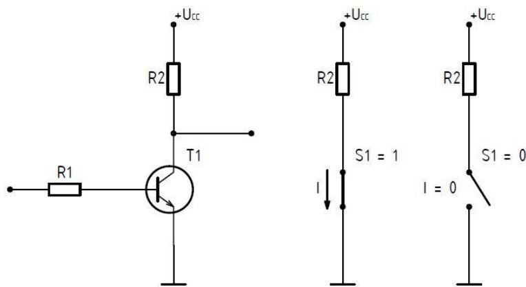
Slika 38: Tranzitorska sklopka s bipolarnim NPN tranzistorom
