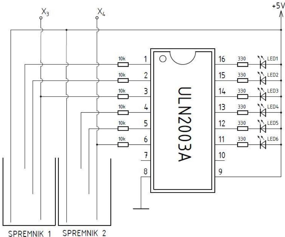
Slika 50: Sklop za određivanje količine napitka unutar spremnika
