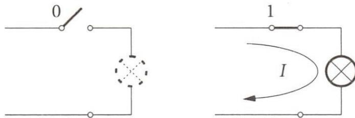
Slika 1: Predočavanje binarnih veličina mehaničkom sklopkom (prekidačem) [1]
