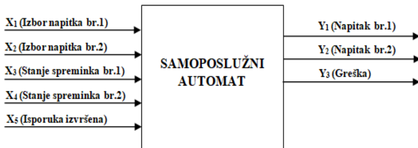
Slika 34: Složenija izvedba samoposlužnog automata za napitke
