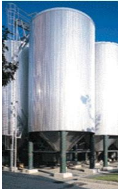
Slika 3. Cilindrično-konusni fermentori (CKF)
