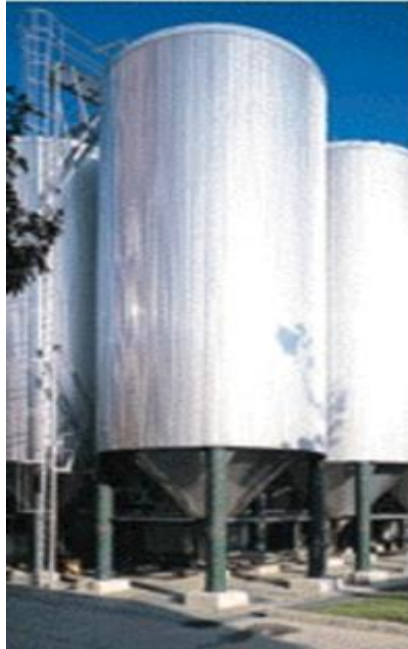
Slika 3. Cilindrično-konusni fermentori (CKF)
