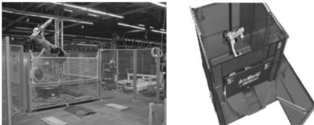
Slika 21. Zaštita radnog područja robota mehaničkom barijerom
