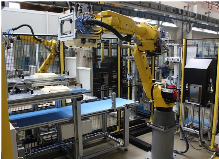
Slika 19. Robotska automatizacija injekcijsko prešanja
