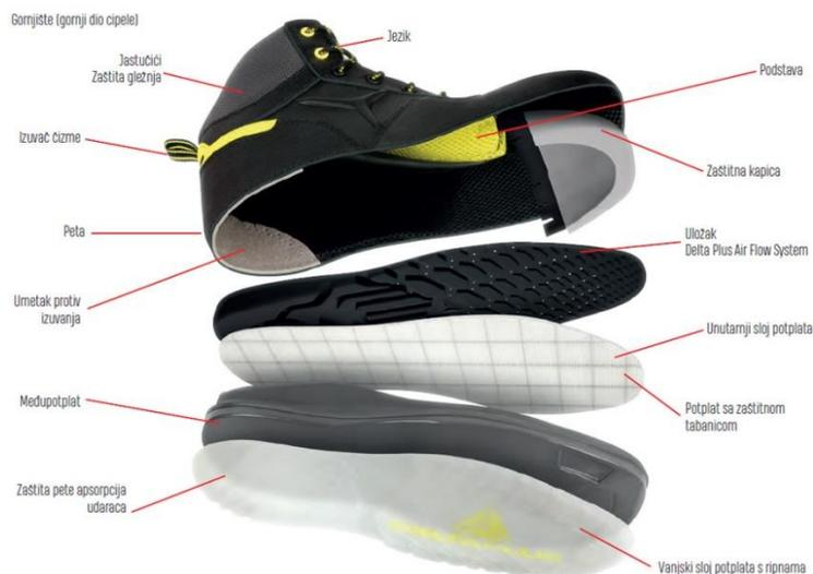
Slika 19. Dijelovi zaštitne cipele s kapicom [10]
