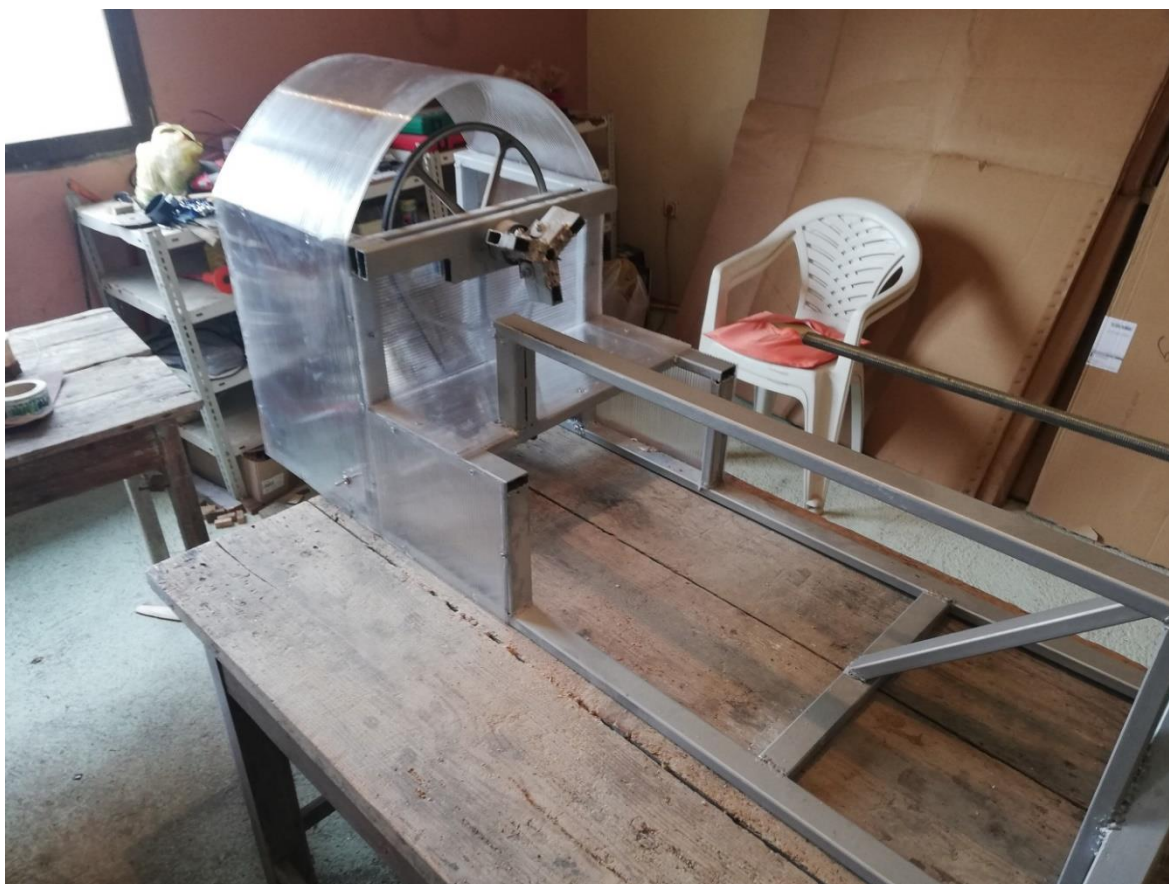
Slika 33. Gotovi tokarski stroj za drvo
