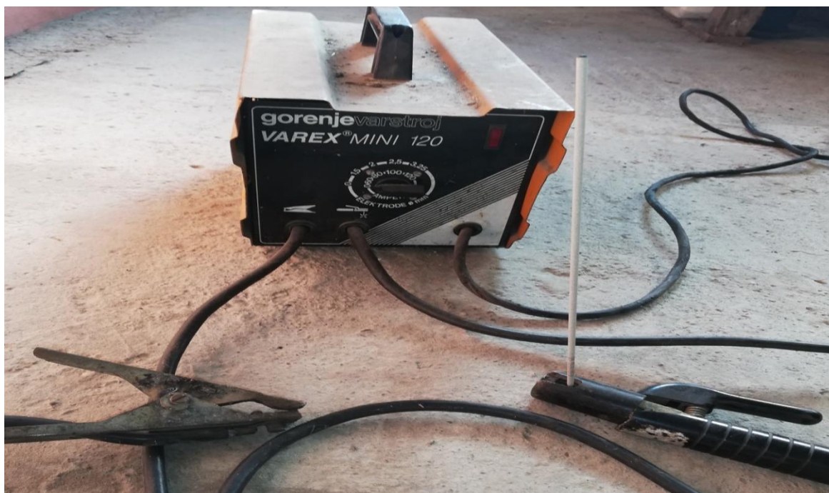
Slika 28. Aparat za zavarivanje
