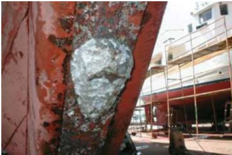
Slika 8. Katodna zaštita žrtvovanom anodom ( www.fsb.unizg.hr/korozija/ )
