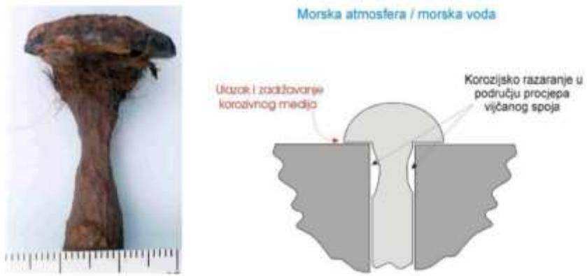
**Slika 6.** Korozjska oštećenja čeličnog vijka za učvršćivanje brodskog motora (lijevo) i shema mehanizma oštećivanja u području procjepa vijčanog spoja (desno) (Alar, 2015.).
