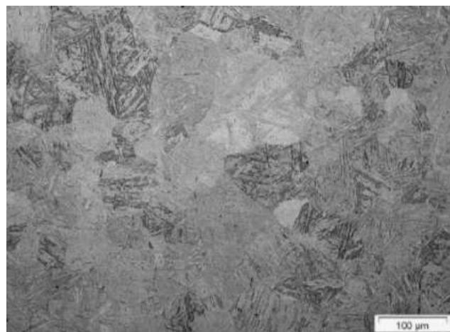
**Slika 4.** Mikrostruktura martenzitnog čelika kvalitete AISI 410 (EN 1.4003) (Voort, 2011.)
