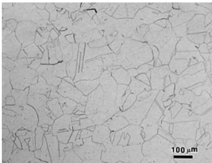
**Slika 2.** Mikrostruktura austenitnog čelika kvalitete AISI – 316 (EN 1.4401) (Voort, 2017.)
