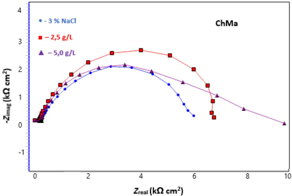
**Slika 17.** Niquistov prikaz EIS spektara čelika X6CrNiTi18-10 u 3% otopini NaCl bez i sa dodatkom ChMa pri 25°C.
