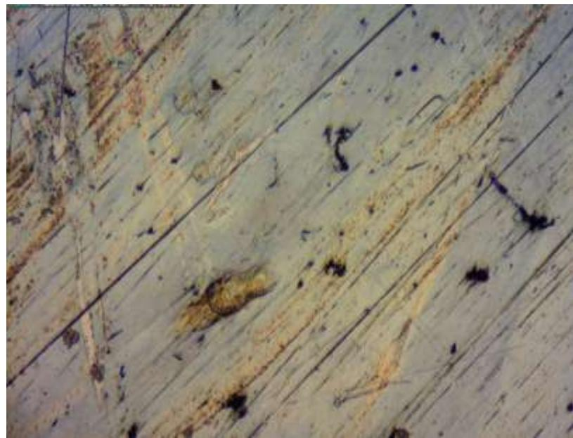
**Slika 23.** Površine čelika X6CrNiTi18-10 snimljene optičkim metalografskim mikroskopom (250X) nakon 60 dana izlaganja u 3% NaCl.s dodatkom 2,5 g/L eutektičkog otapala prolin:
