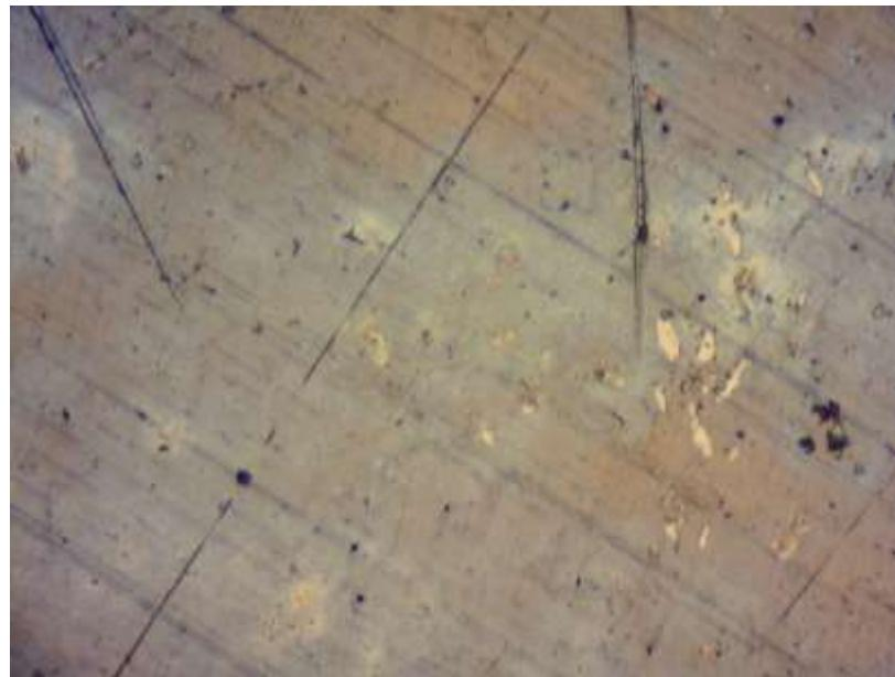
**Slika 21.** Površine čelika X6CrNiTi18-10 snimljene optičkim metalografskim mikroskopom (250X) nakon 60 dana izlaganja u 3% NaCl s dodatkom 2,5 g/L eutektičkog otapala kolin-klorid: limunska kiselina (ChCit).
