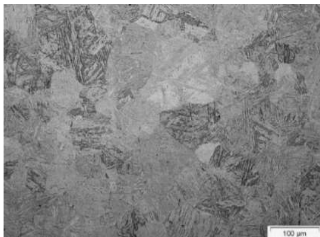
Slika 4. Mikrostruktura martenzitnog čelika kvalitete AISI 410 (EN 1.4003) (Voort, 2011.)
