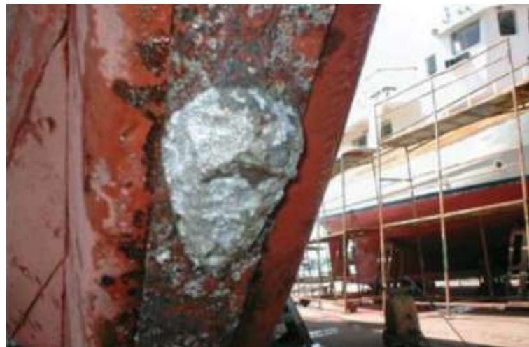
**Slika 8.** Katodna zaštita žrtvovanom anodom ([www.fsb.unizg.hr/korozija/](http://www.fsb.unizg.hr/korozija/))
