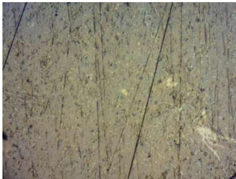
**Slika 22.** Površine čelika X6CrNiTi18-10 snimljene optičkim metalografskim mikroskopom (250X) nakon 60 dana izlaganja u 3% NaCl.s dodatkom 2,5 g/L eutektičkog otapala betain:
