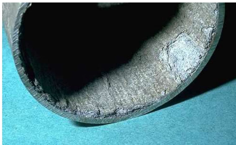
Slika 15. Selektivna korozija (INSA, 2017.)
