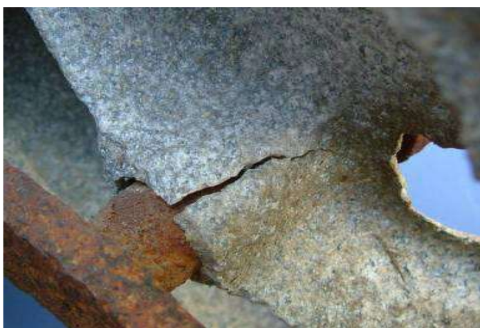
Slika 9. Lom steznog zatvarača (Alar, 2015.)
