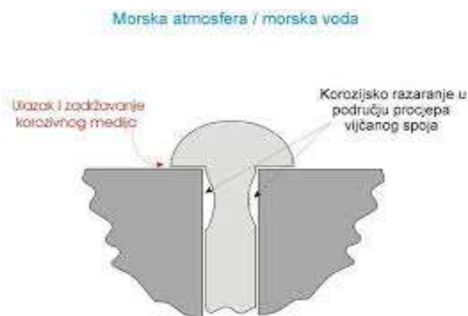
Slika 13. Korozija u procijepu uzrokovana morskom vodom (Alar, 2015.)
