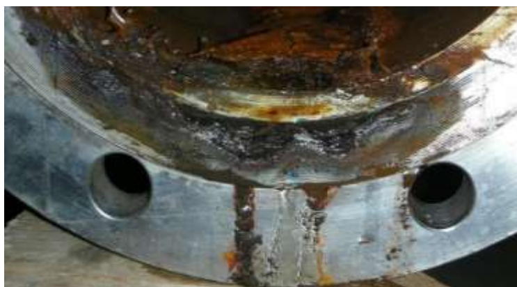
Slika 12. Korozija uzrokovana staništem mikroorganizama (Alar, 2015.)
