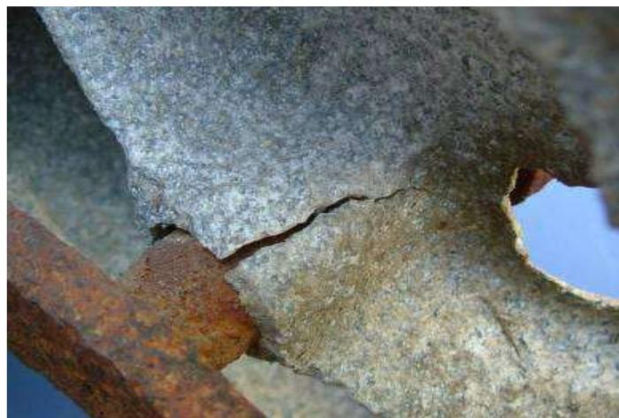
**Slika 9.** Lom steznog zatvarača (Alar, 2015.)
