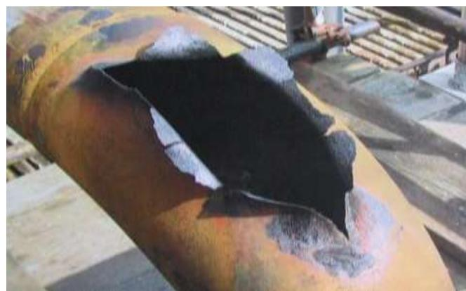
**Slika 14.** Oštećenje na cjevovodu uzrokovano erozijskom korozijom (Alar, 2015.)
