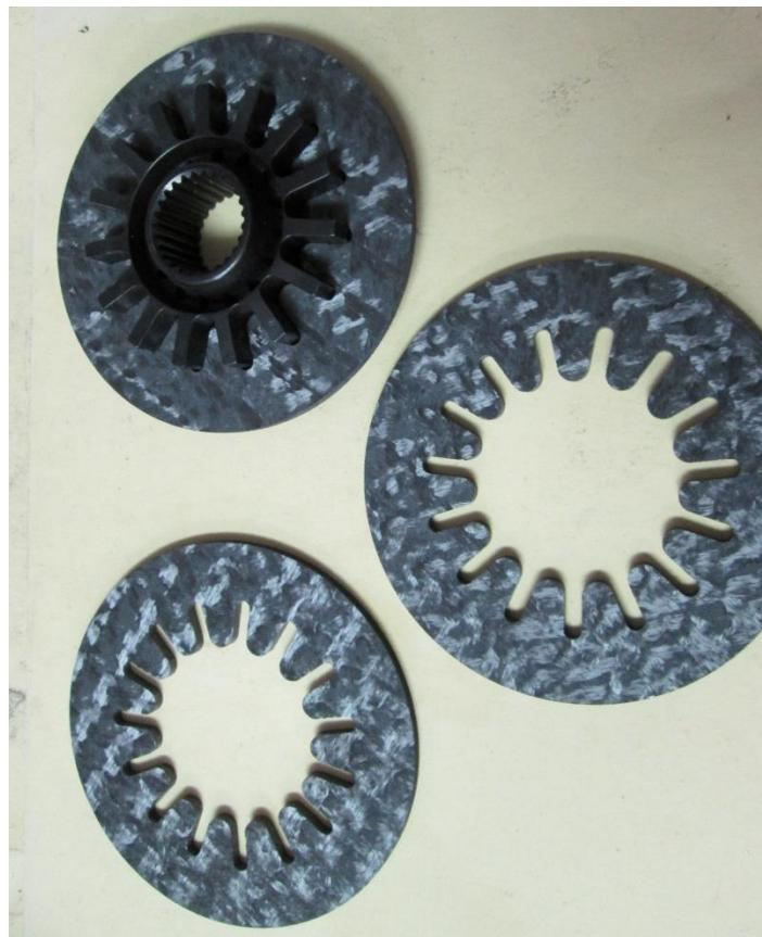
**Slika 58. Proba unutarnje lamele s jezgrom spojke**
