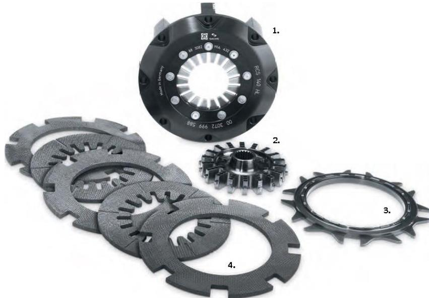
**Slika 9. Dijelovi spojke s ugljičnim oblogama [5]**
