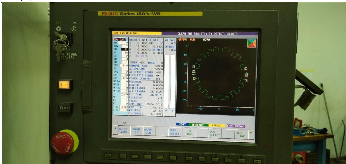
Slika 53. Provjera putanje na upravljačkoj jedinici stroja
