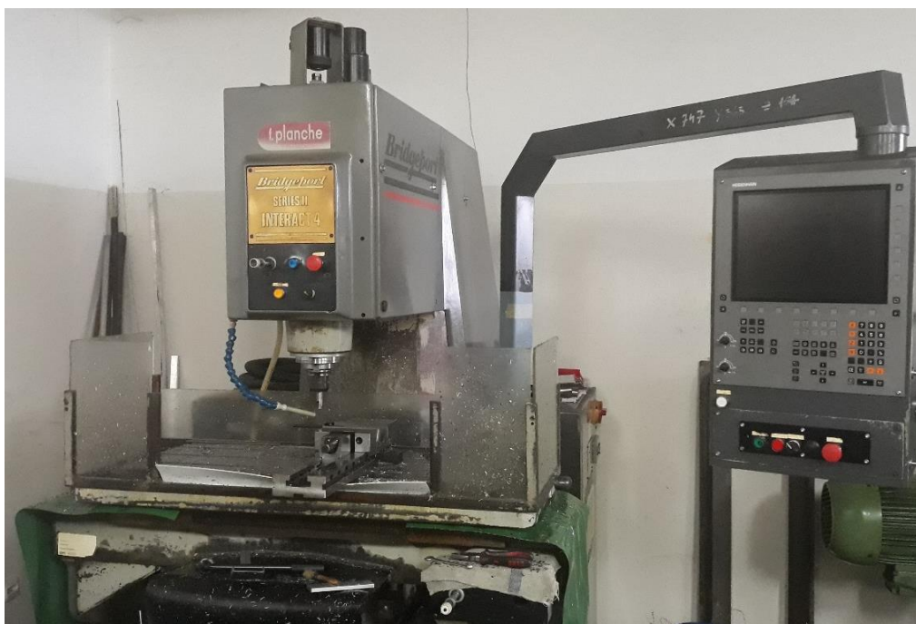
Slika 45. CNC glodalica Bridgeport Interact 4
