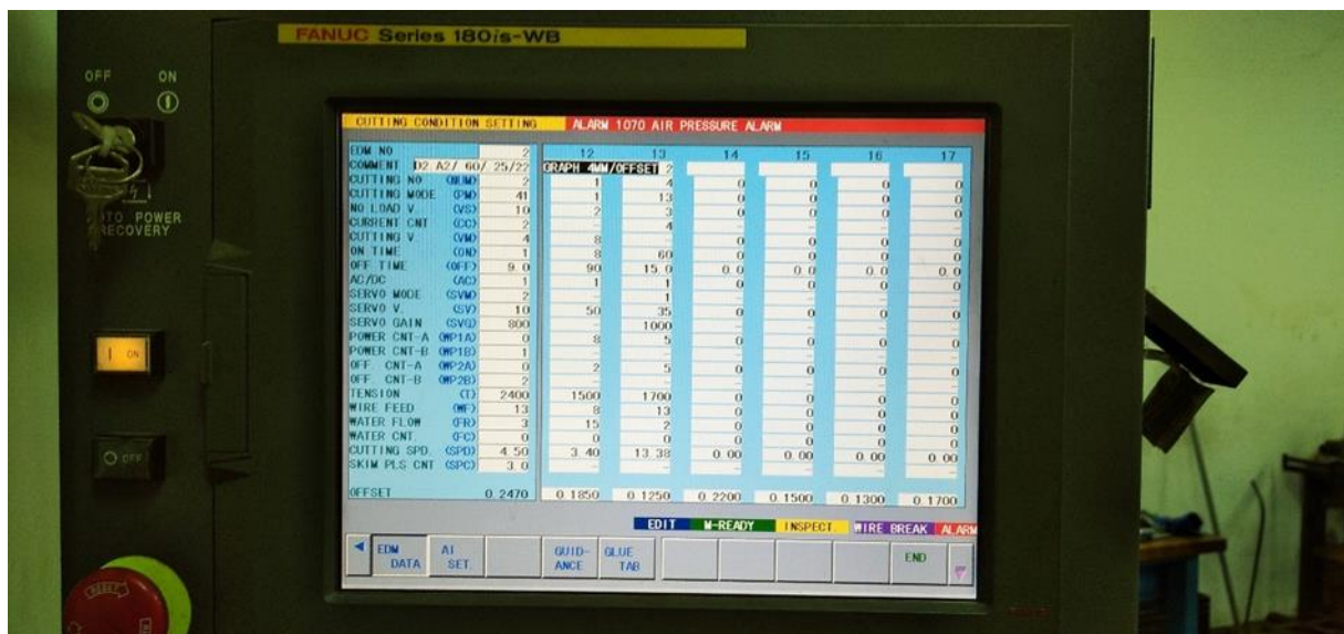
Slika 54. Parametri rezanja za ugljična vlakna
