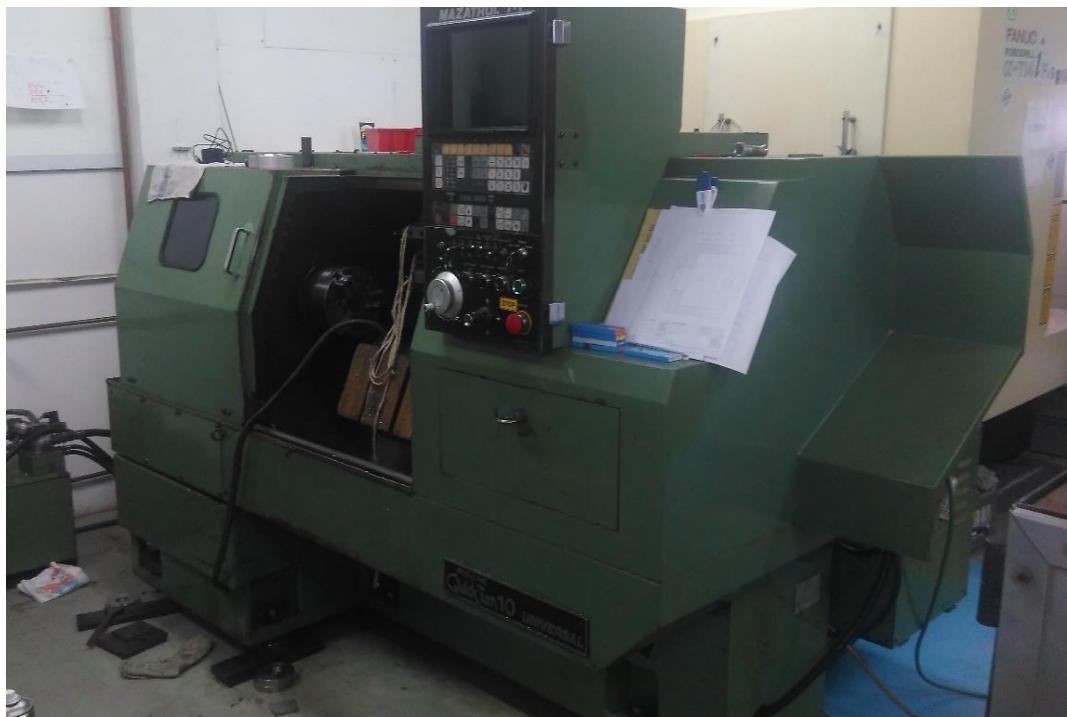
**Slika 28. CNC Tokarilica Mazak QuickTurn 10**
