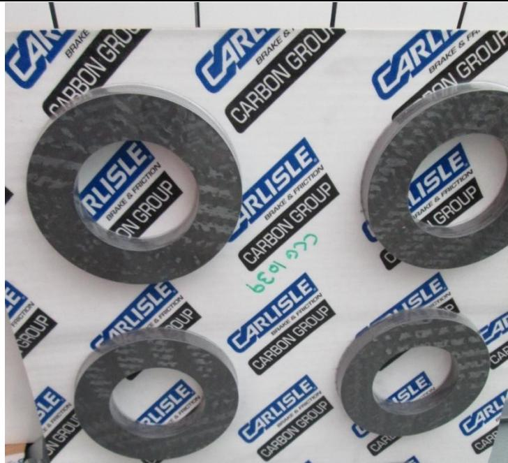
**Slika 57. Sirove pločice od ugljičnih vlakana**
