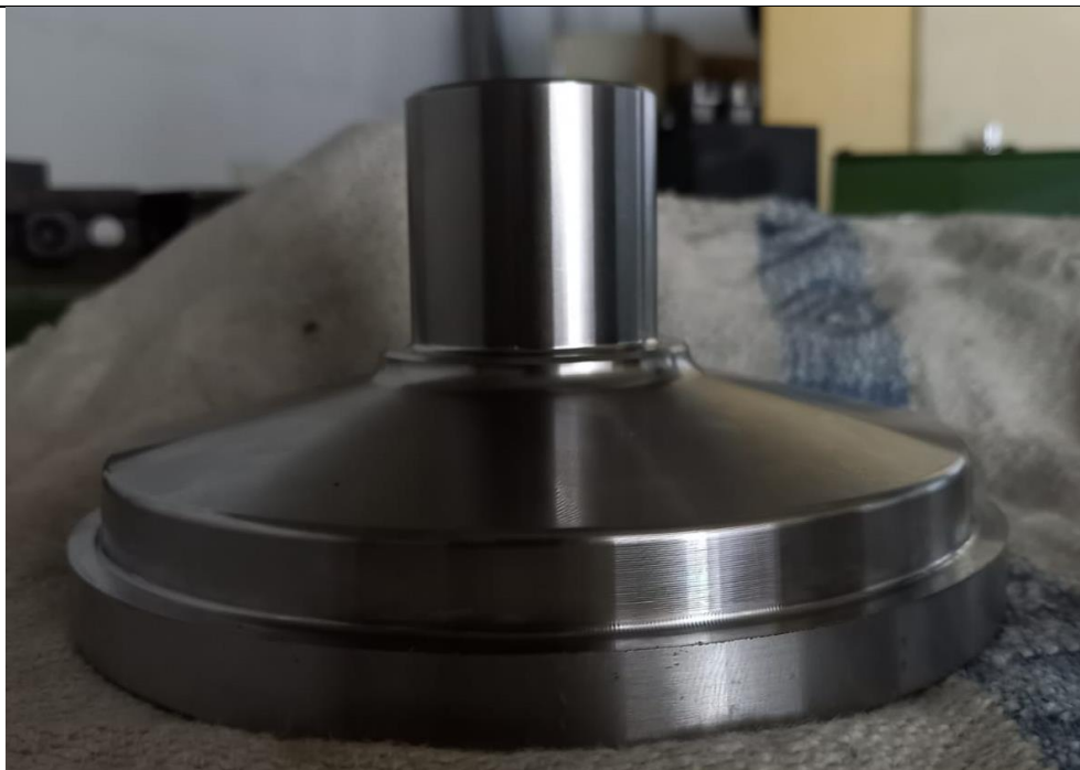
Slika 36. Potokaren poklopac spojke
