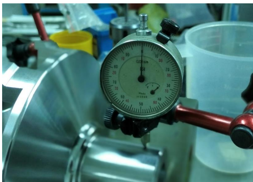
Slika 49. Provjera cilindričnosti na prizmama
