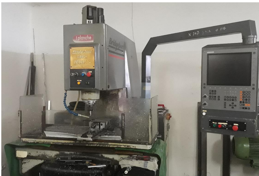
Slika 45. CNC glodalica Bridgeport Interact 4
