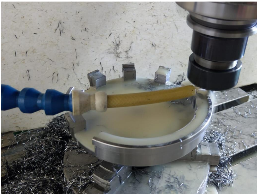
Slika 46. Glodanje poklopca spojke
