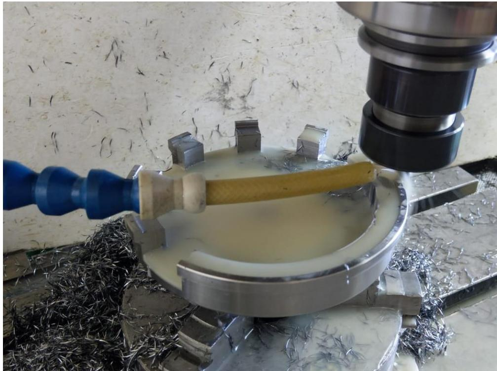
**Slika 46. Glodanje poklopca spojke**
