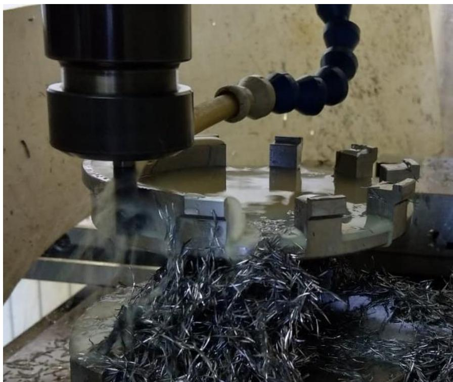
**Slika 47. Glodanje poklopca korpe spojke**
