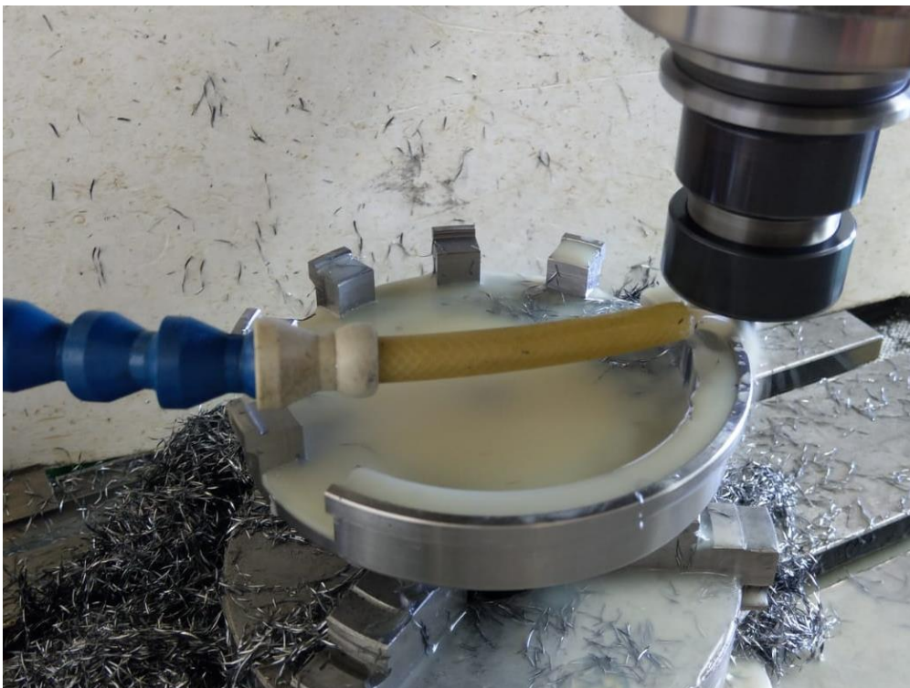
Slika 46. Glodanje poklopca spojke
