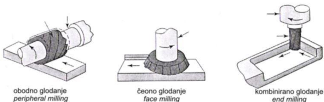
Slika 38. Osnovni primjeri primjene glodanja
