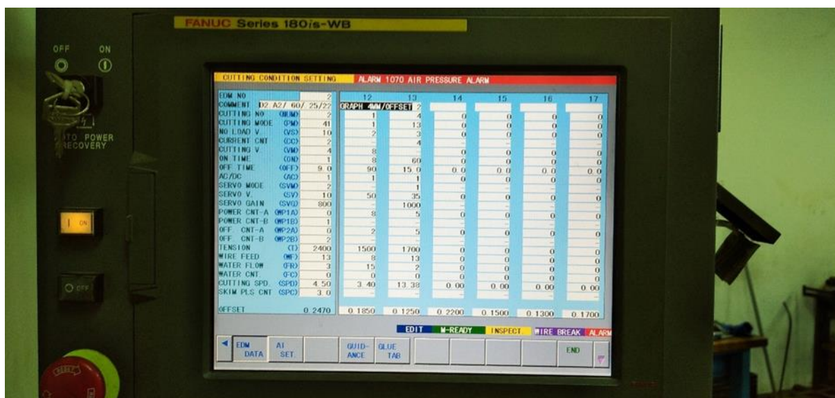
Slika 54. Parametri rezanja za ugljična vlakna
