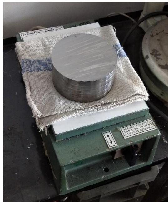
**Slika 27. Demagnetizacija sirovca**
