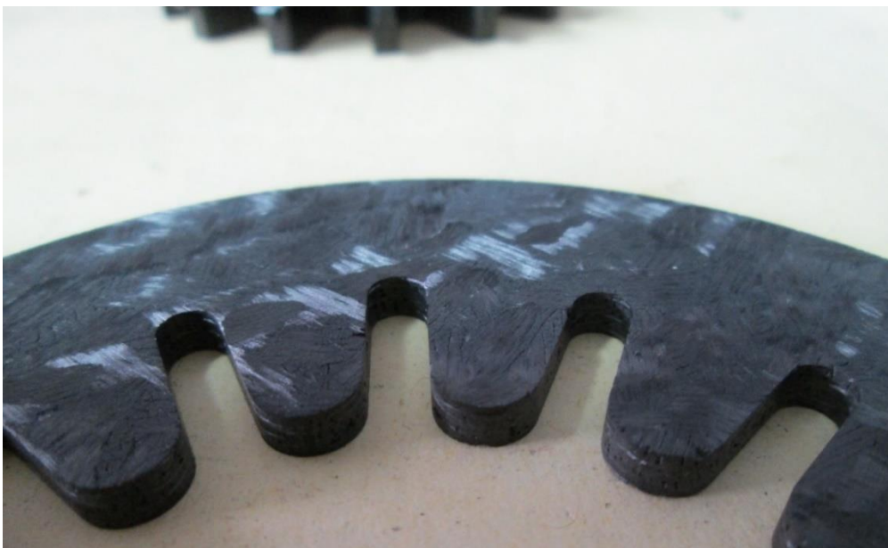
Slika 59. Vizualna kontrola obrađene površine
