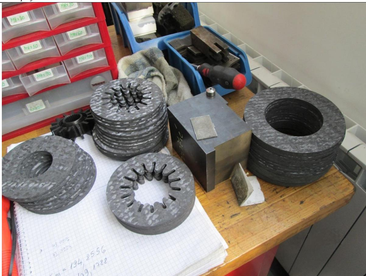
Slika 61. Lamele spremne za ugradnju
