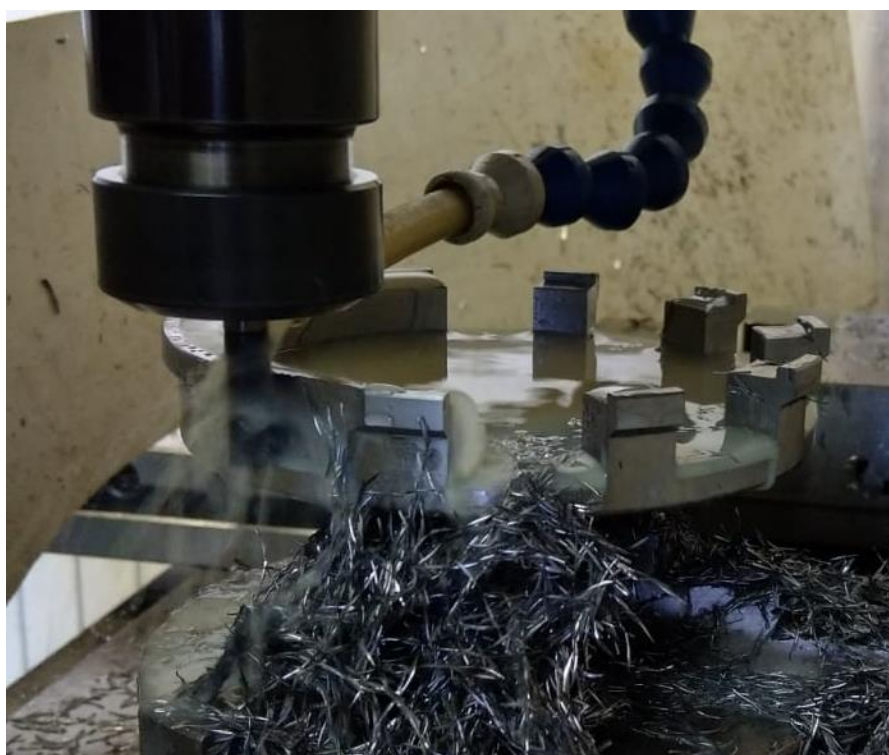
Slika 47. Glodanje poklopca korpe spojke
